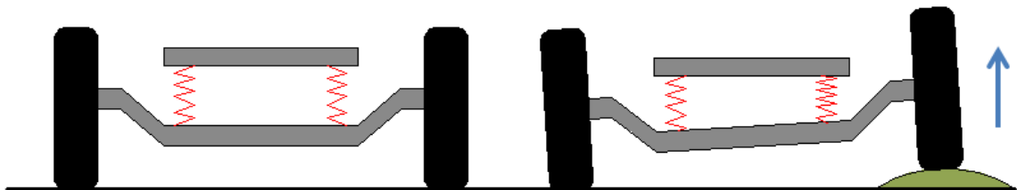
Slika 2.27 Shematski prikaz zavisnog ovjesa u neutralnom i opterećenom stanju [20]
