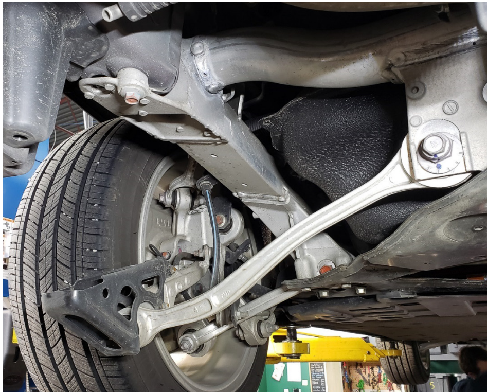
Slika 2.38 Višezglobni ovjes kod Honde Clarity (2018. god.) [27]
