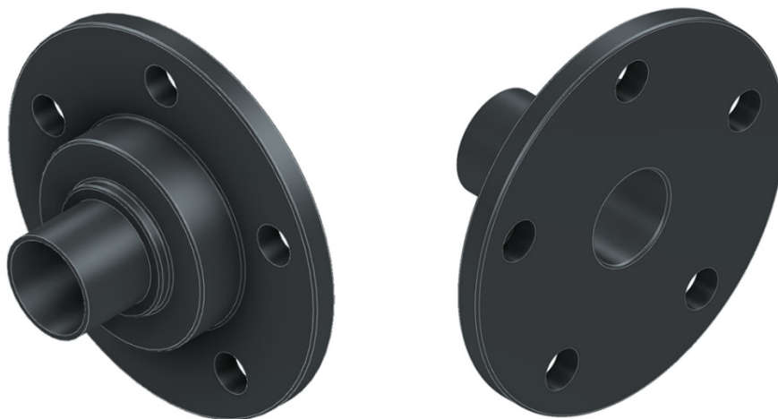
Slika 5.10 Modelirana glavčina kotača iz dva pogleda
