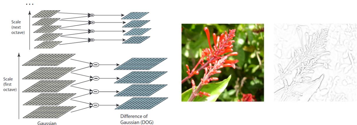
Slika 3: Metoda DoG: Shematski prikaz oduzimanja slika različite zamućenosti(ljevo). Rezultat oduzimanja(desno)
