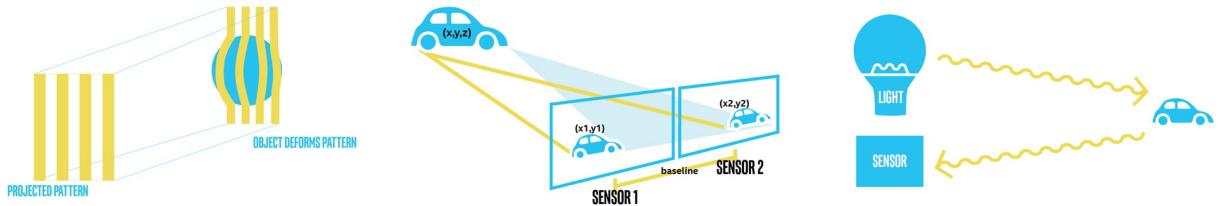
Slika 11: Ilustracije različitih metoda računanja dubine: Strukturirano svjetlo(ljevo), stereo dubina(u sredini), vrijeme leta - LiDAR (desno)
