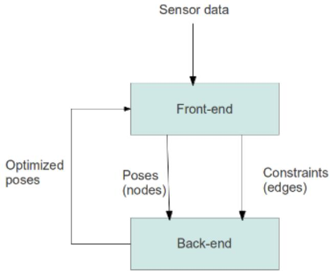
Slika 1: Shema optimizacijskog pristupa: *frontend* i *backend*
