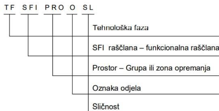
Slika 4.5. Klasifikacijska šifra radioničkog nacrt [14]
