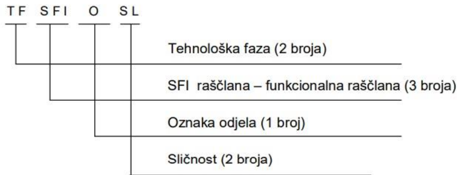
Slika 4.4. Klasifikacijska šifra projektnog nacrt [14]
