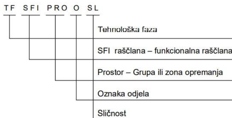
Slika 4.5. Klasifikacijska šifra radioničkog nacrt [14]
