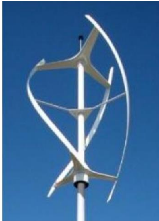
Slika 3.8. Darrieusova vjetroturbina sa spiralnim lopaticama [10]
