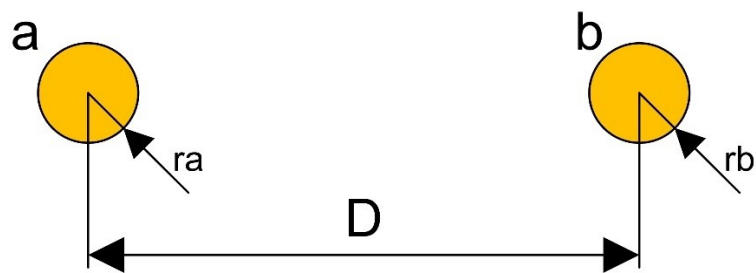
Slika 4.15. Dva paralelna vodiča
