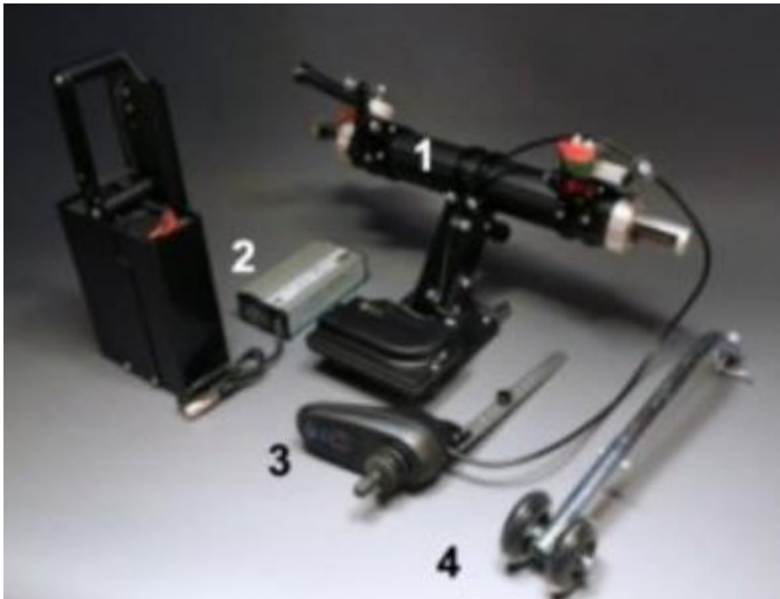
Slika 4.6. Dijelovi pogonskog dodatka „Light drive power assist“ [19]
