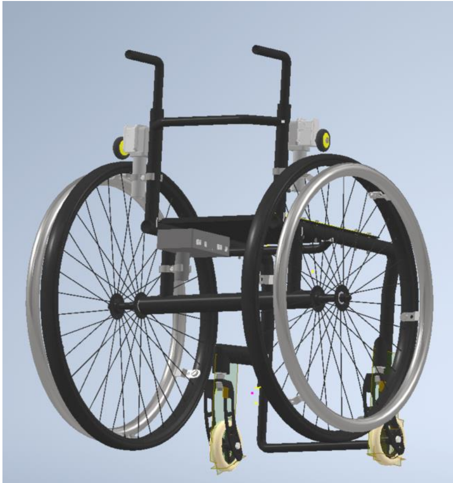
Slika 6.8. Sklop invalidskih kolica s pogonskim dodatkom
