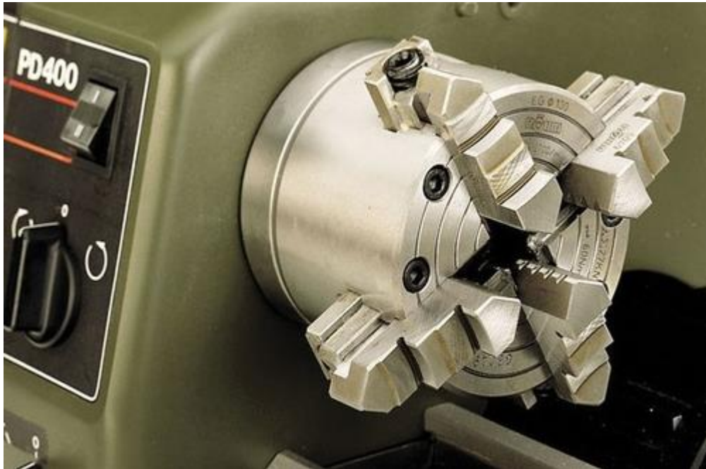
Slika 5.2 PROXXON 4 - čeljusna stezna glava sa nezavisnim čeljustima
