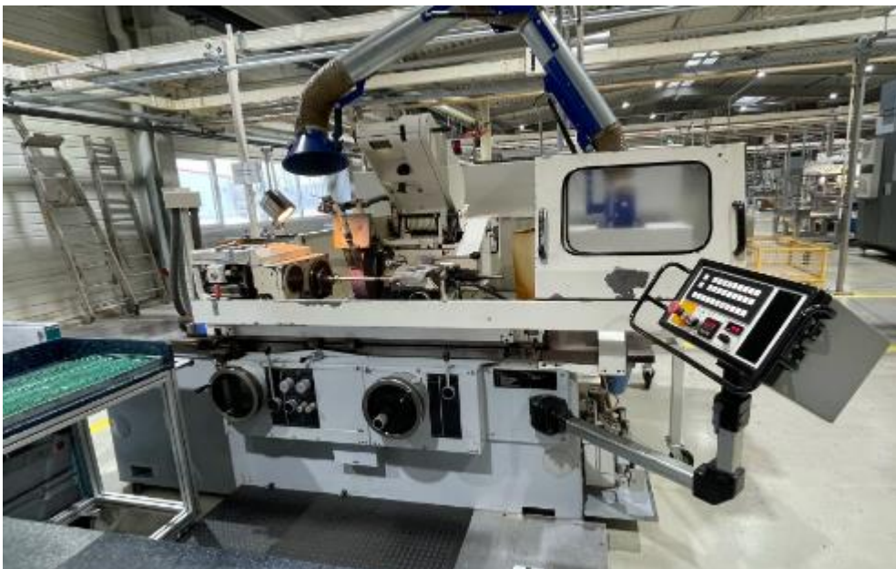
Slika 5.44 Brusilica "SCHLEIFMASCHINENWERK CHEMNITZ SA 5/2Ux630"
