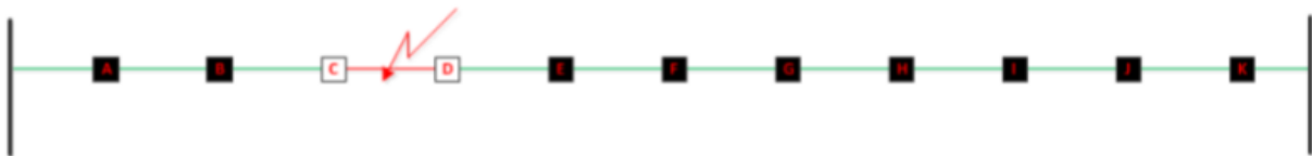
Slika 5.3. Rekonfigurirana mreža i spremna za ponovni uklop [2]
