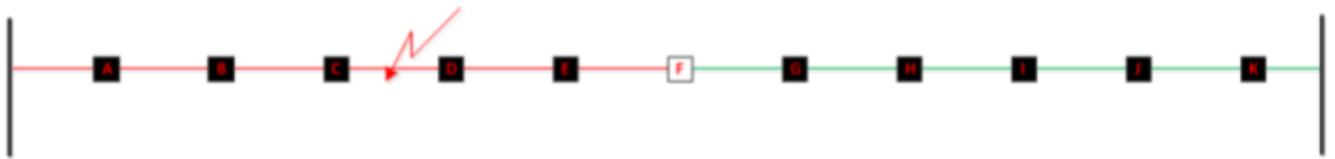
Slika 5.2. Kvar na mreži između čvorova „C“ i „D“ [2]
