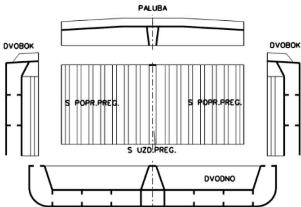
Slika 6.5. Montažne jedinice na presjeku glavnog rebra [6]
