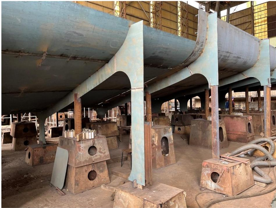
*Slika 4.4. Izrada sekcije pomoću kolijevke*
