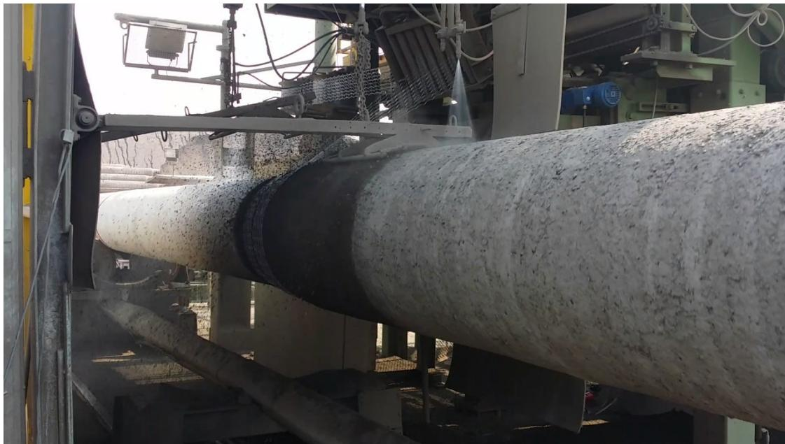
Slika 3.8. Prikaz cementiranja cijevi [43]
