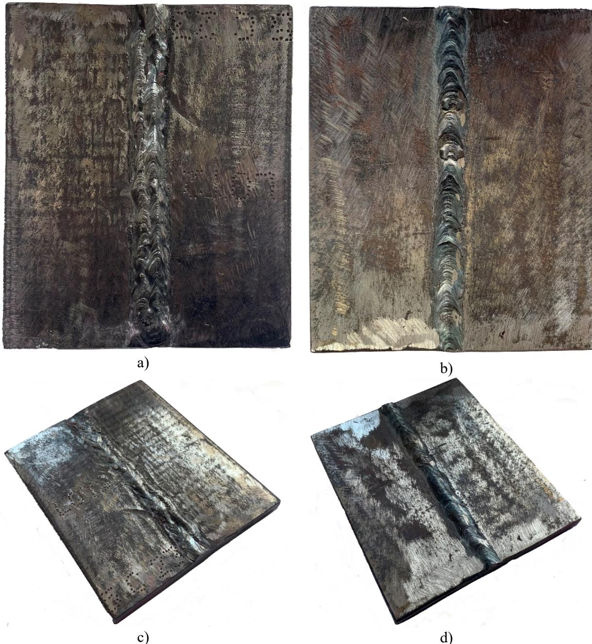
Slika 5.12. Uzorak 2-1: a) lice zavara, b) korijen zavara, c) lice zavara izometrija, d) korijen zavara izometrija
