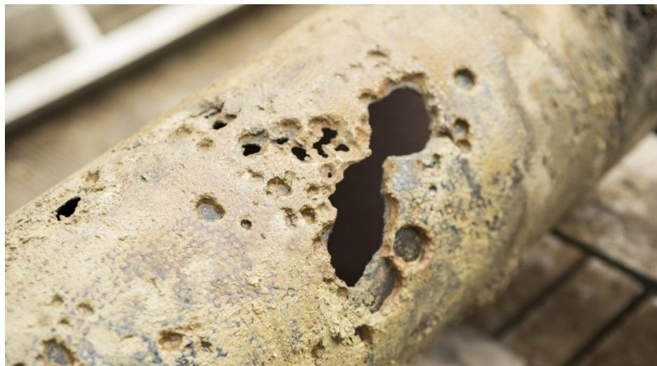
Slika 2.16. Primjer rupičaste korozije na cijevi [18]
