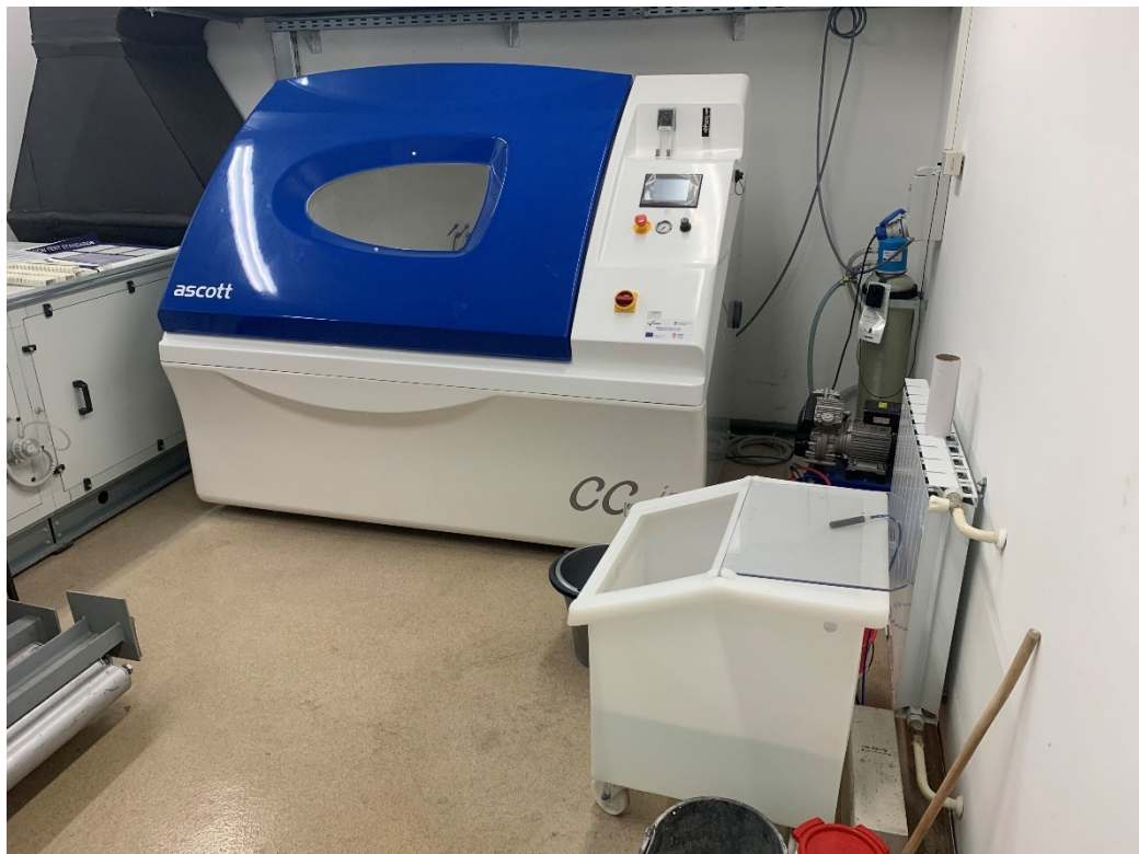
Slika 5.20. Slana komora Ascott CC1000ip
