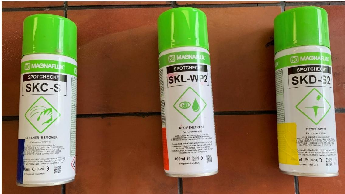
Slika 5.16. Sprejevi za testiranje penetrantima s lijeva na desno, čistač, penetrant i razvijač
