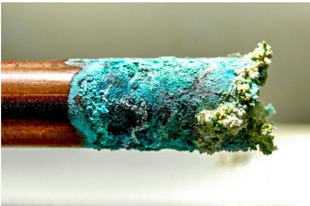
Slika 2.8. Korozija bakrene cijevi [12]
