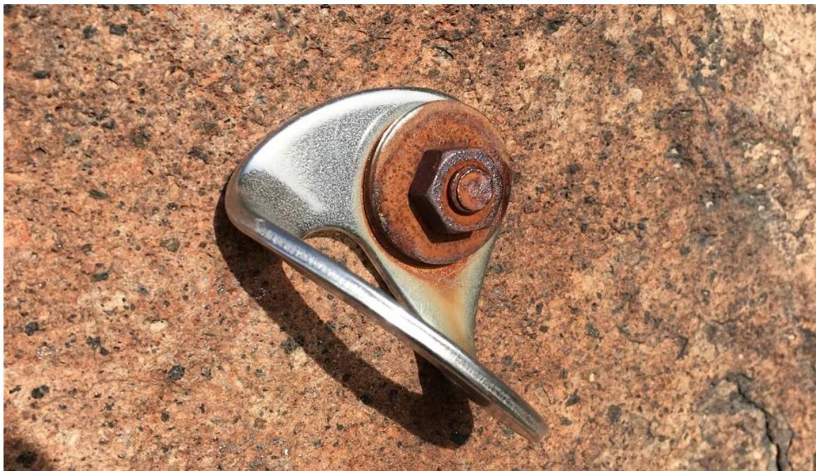
Slika 2.19. Primjer galvanske korozije [22]
