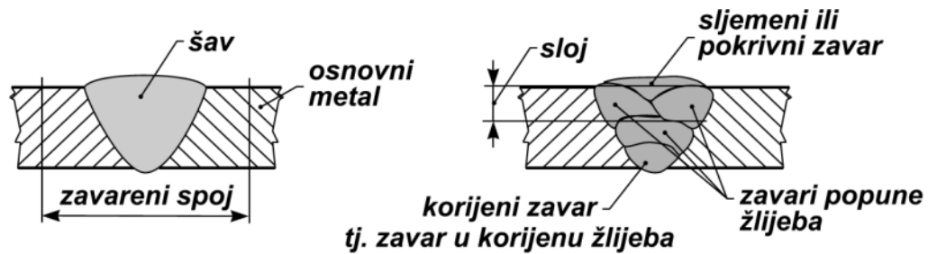
Slika 4.1. Prikaz skice zavarenog spoja s elementima [49]
