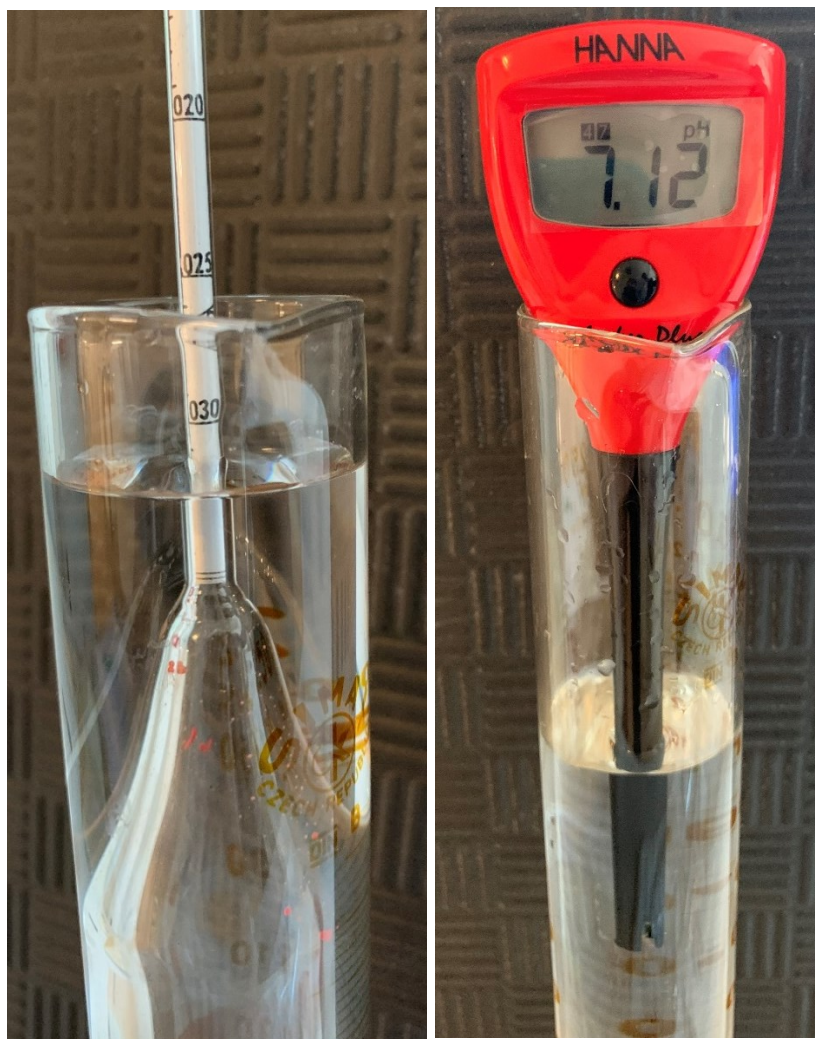
Slika 5.41. Gustoća i pH vrijednost otopine NaCl nakon 168 sati
