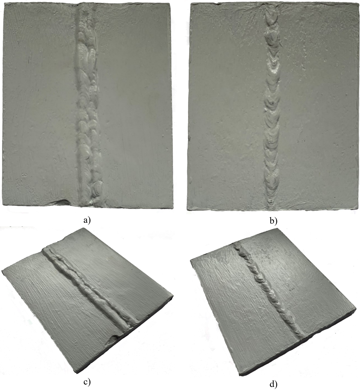
Slika 5.10. Uzorak 1-3: a) lice zavora, b) korijen zavora, c) lice zavora izometrija, d) korijen zavora izometrija
