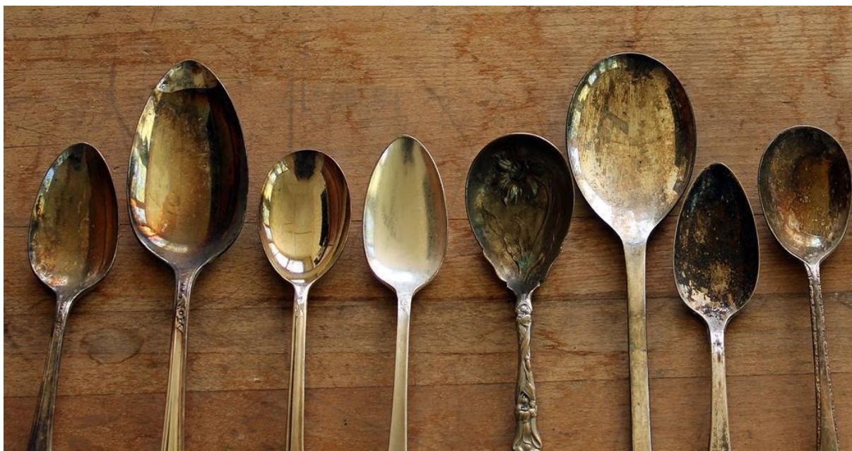
Slika 2.7. Korozija srebrnog pribora za jelo [11]
