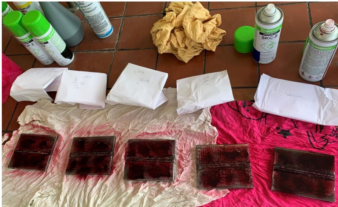
Slika 5.18. Nanošenje penetranta
