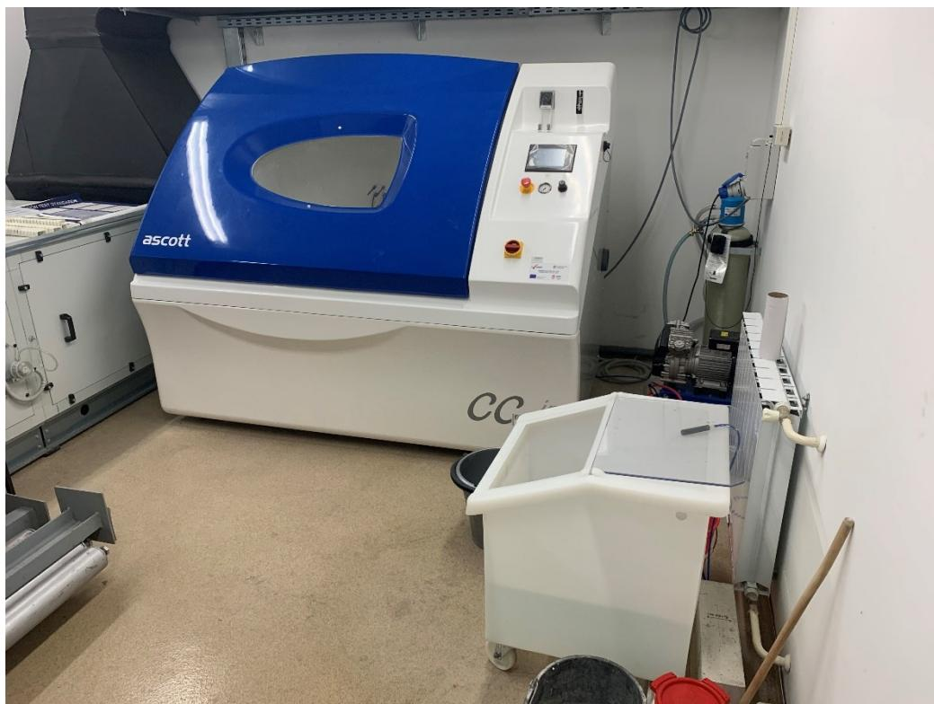
Slika 5.20. Slana komora Ascott CC1000ip
