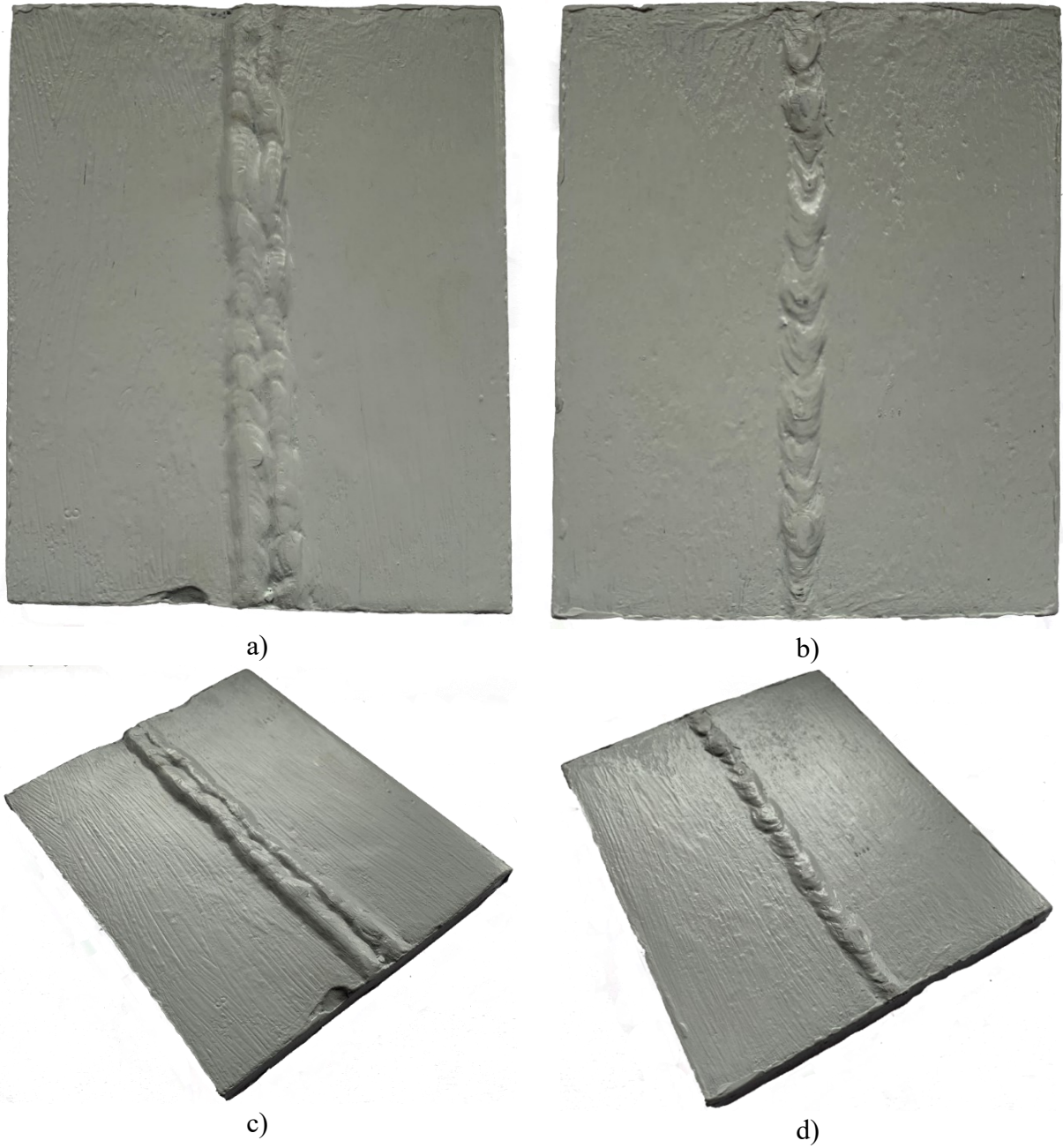
Slika 5.10. Uzorak 1-3: a) lice zavara, b) korijen zavara, c) lice zavara izometrija, d) korijen zavara izometrija
