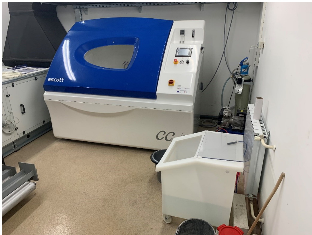
Slika 5.20. Slana komora Ascott CC1000ip
