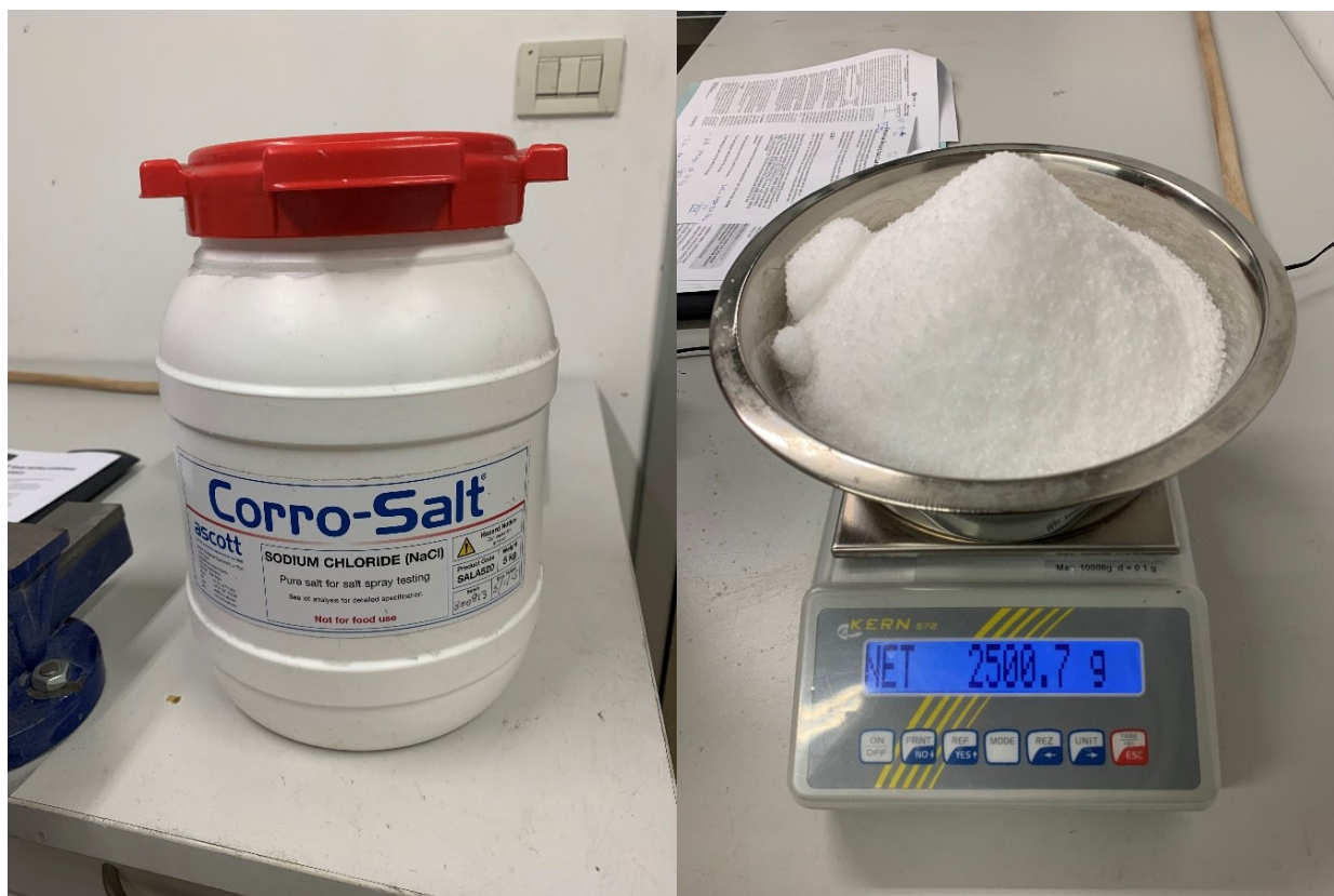
Slika 5.23. Corro-Salt specijalizirana sol za Ascott slanu komoru
