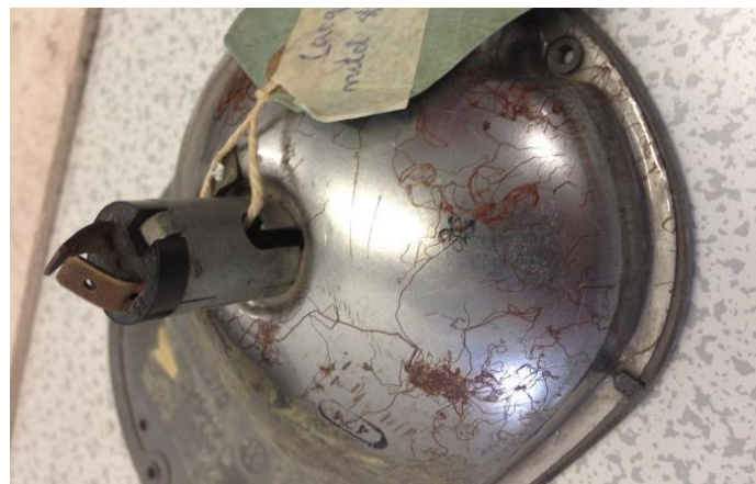
Slika 3.8. Filiformna korozija metalnog kućišta automobilskog svjetla [28]
