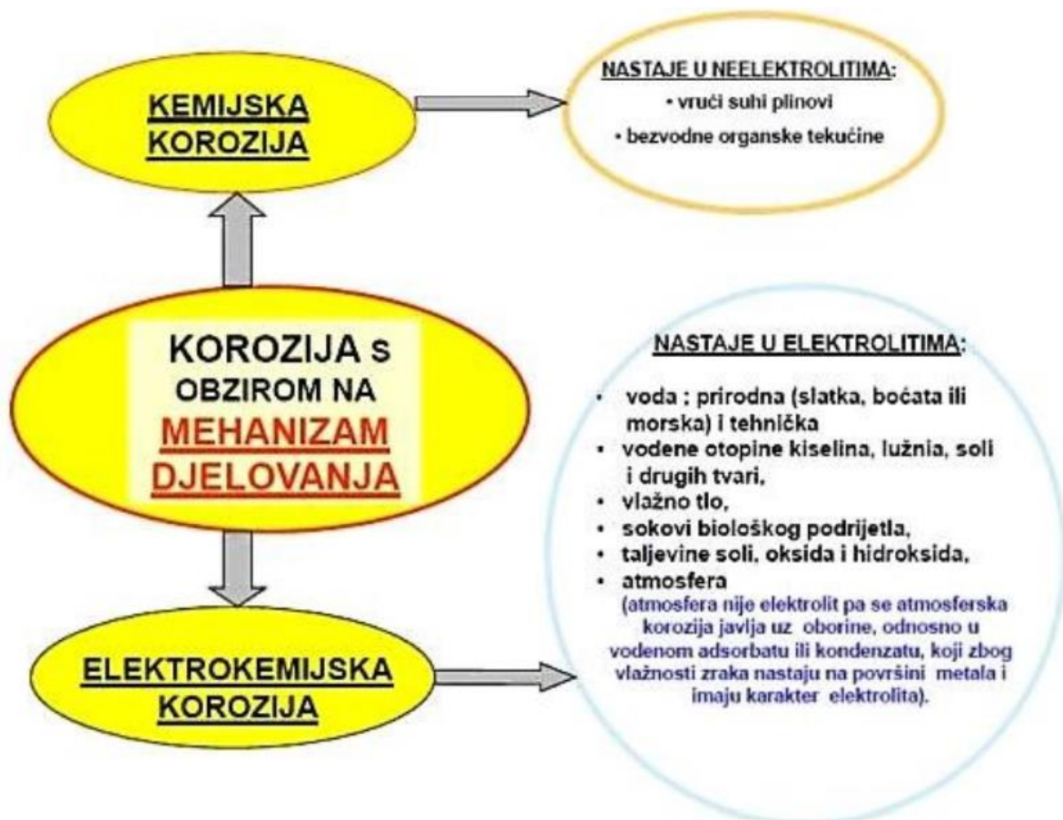
Slika 2.6. Podjela korozije prema mehanizmu djelovanja [6]
