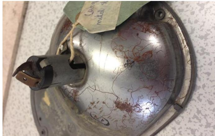
Slika 3.8. Filiformna korozija metalnog kućišta automobilskog svjetla [28]
