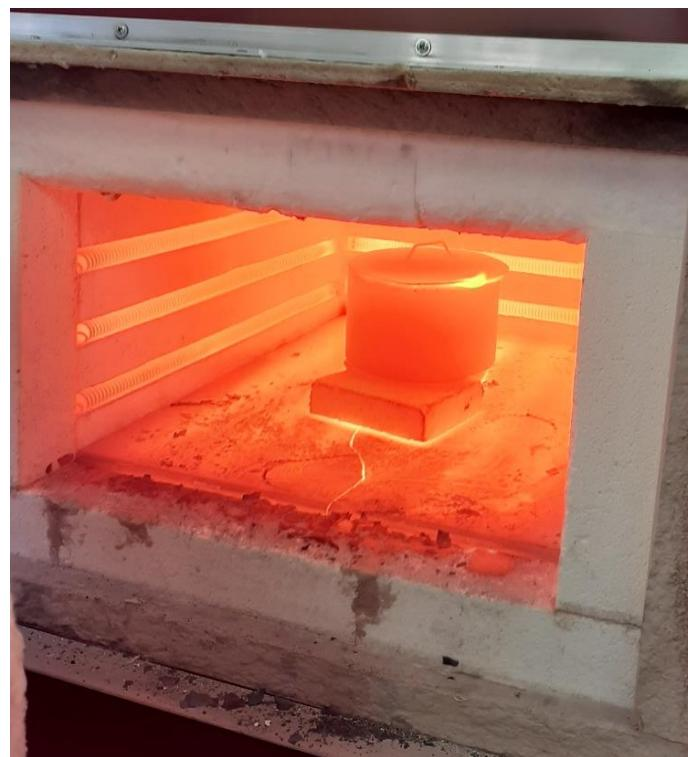
Slika 6.4. Užarena posuda s uzorcima unutar komorne peći
