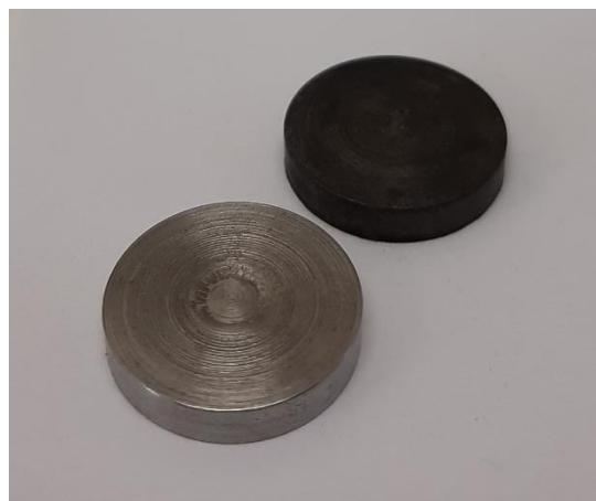
Slika 6.1. Ispitni uzorci prije i nakon toplinske obrade
