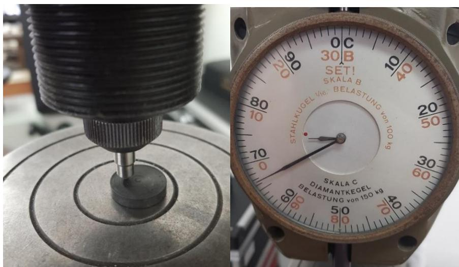
Slika 6.6. Ispitivanje tvrdoće zakaljenog izratka Rockwellovom metodom
