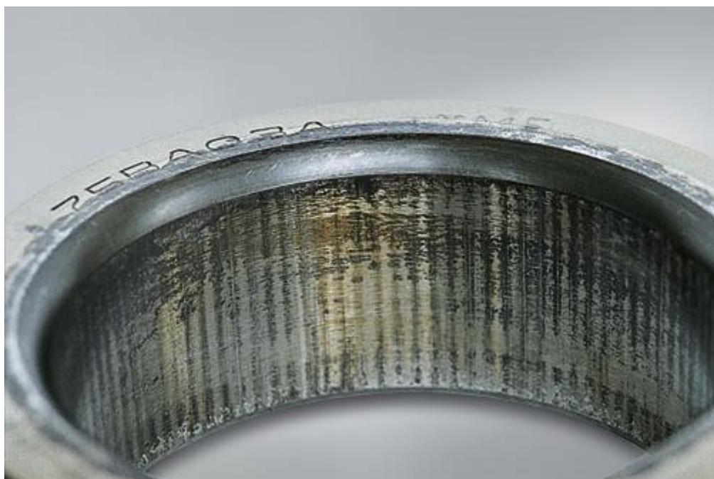
3.19. Tarna korozija unutarnjeg prstena kugličnog ležaja [40]
