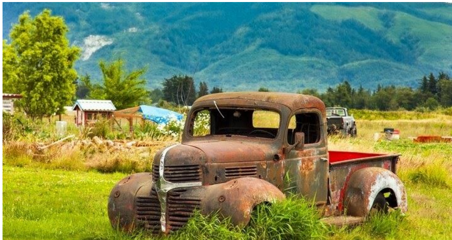
Slika 2.1. Primjer korozije na karoseriji automobila [2]
