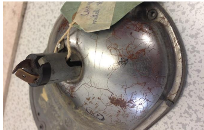
Slika 3.8. Filiformna korozija metalnog kućišta automobilskog svjetla [28]
