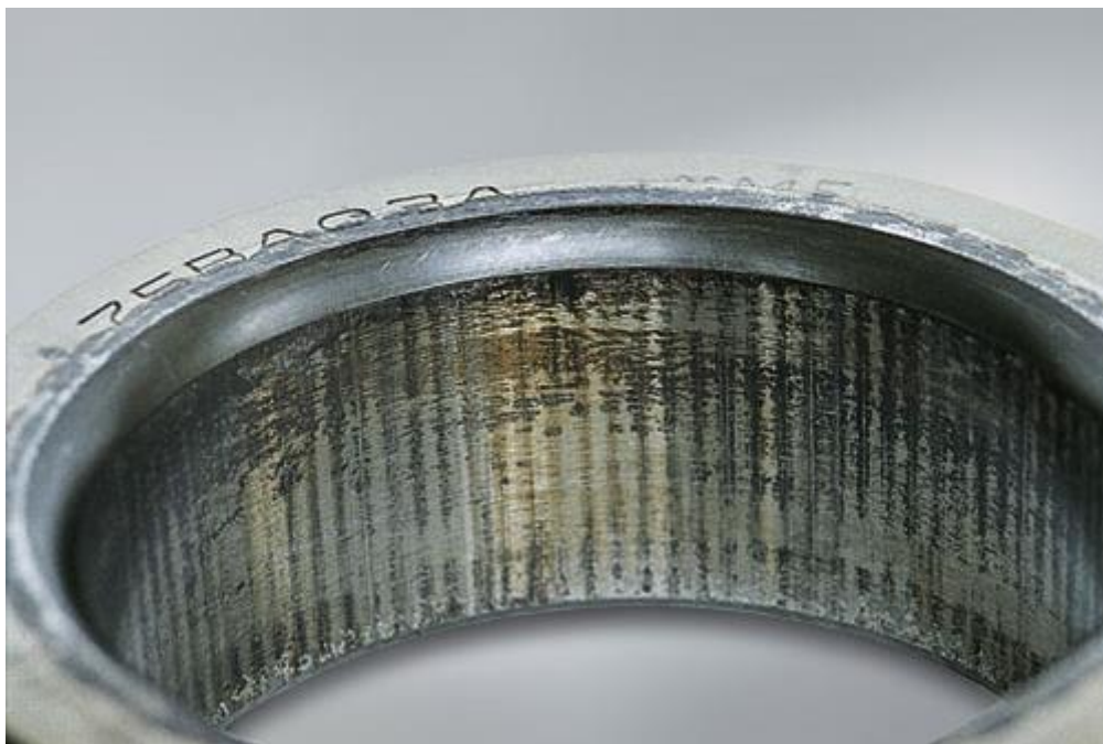
3.19. Tarna korozija unutarnjeg prstena kugličnog ležaja [40]
