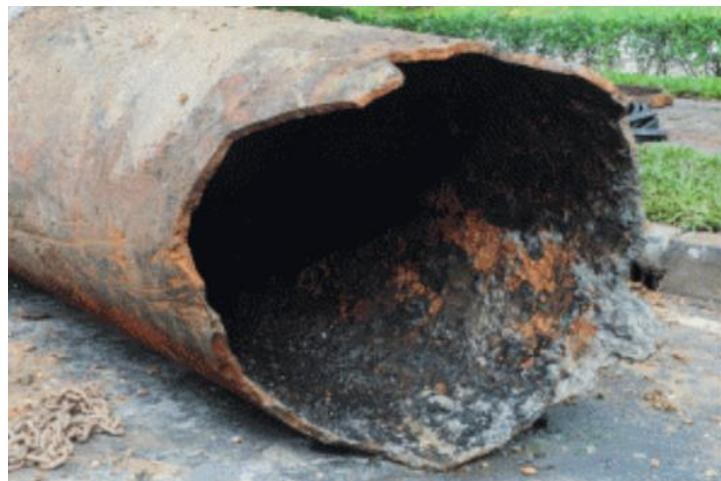
Slika 3.12. Grafitizacija ukopanog cjevovoda od sivog lijeva [32]
