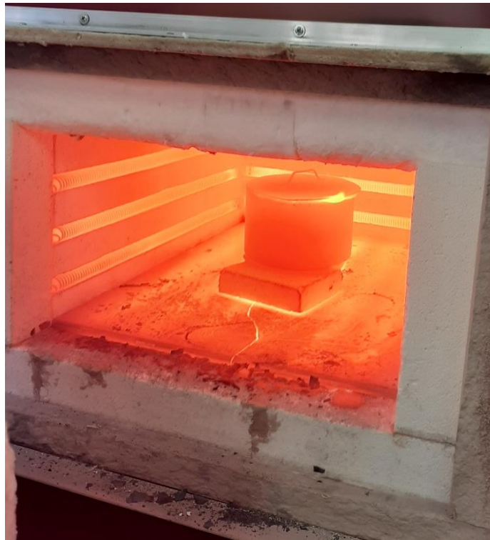
Slika 6.4. Užarena posuda s uzorcima unutar komorne peći
