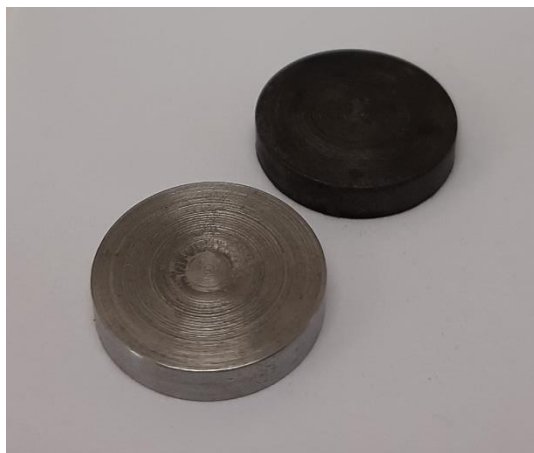
Slika 6.1. Ispitni uzorci prije i nakon toplinske obrade
