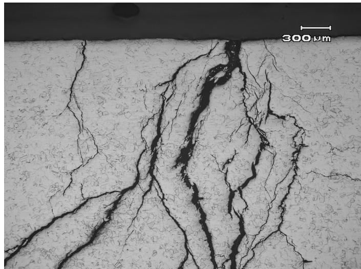
Slika 3.17. Razgranati oblik oštećenja izazvan napetosnom korozijom [38]
