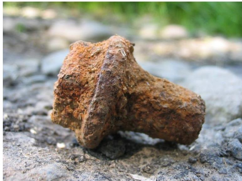
Slika 3.3. Neravnomjerna opća korozija vijka [23]
