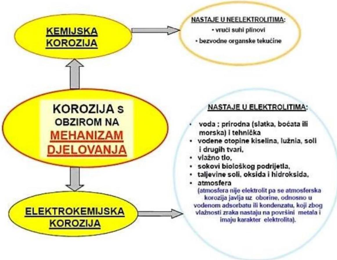
Slika 2.6. Podjela korozije prema mehanizmu djelovanja [6]
