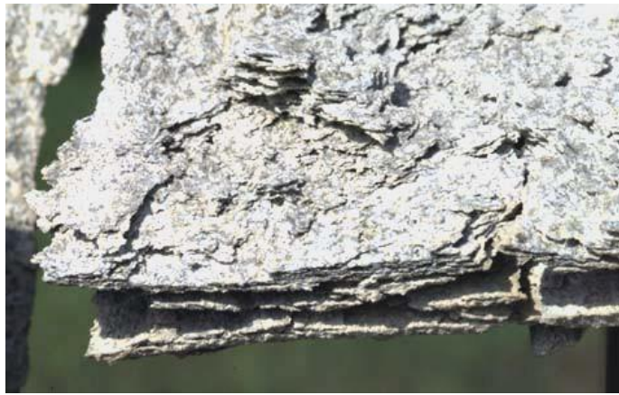
Slika 3.7. Eksfolijacija (raslojavanje, listanje) aluminijeve legure u morskoj sredini [27]
