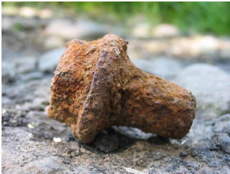
Slika 3.3. Neravnomjerna opća korozija vijka [23]
