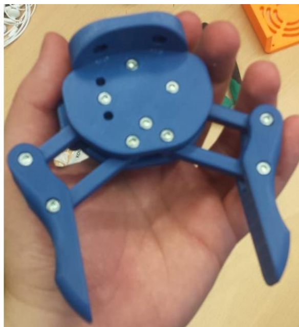
Slika 3.10. Prikaz sprega zupčanika prihvatnice (lijevo), sklop prihvatnice (desno)
