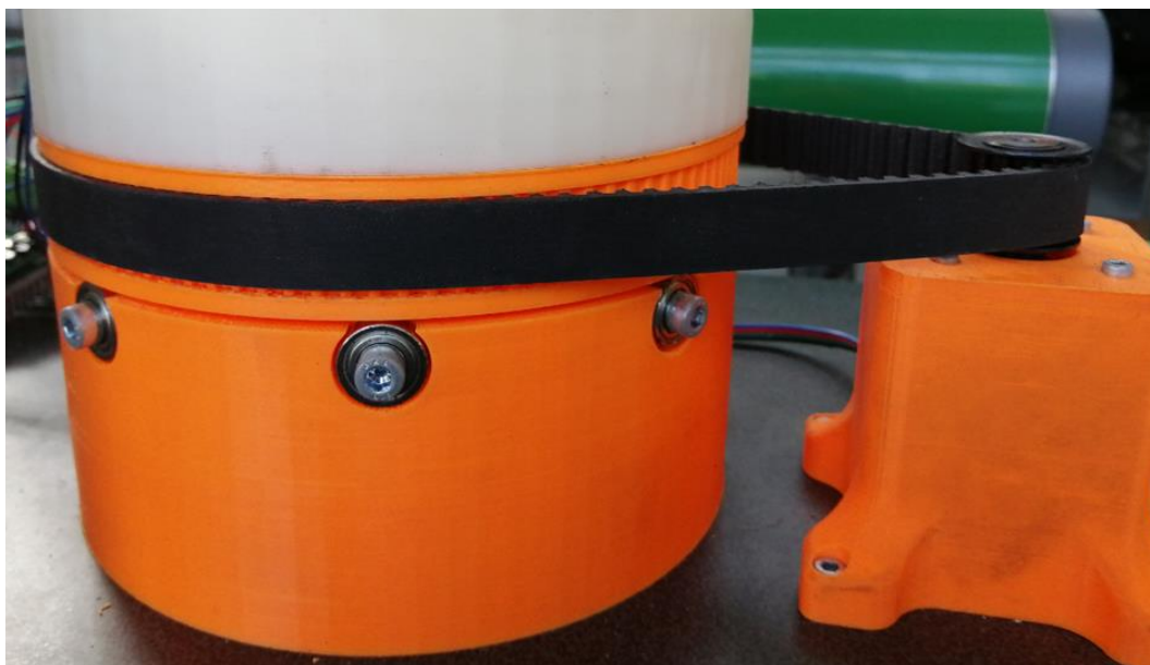
Slika 3.6. Prijenos okretnog momenta zupčastim remenom
