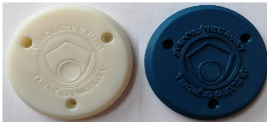
Slika 3.4. Usporedba razine detalja PolyJet tehnologije (lijevo) i FDM tehnologije (desno)
