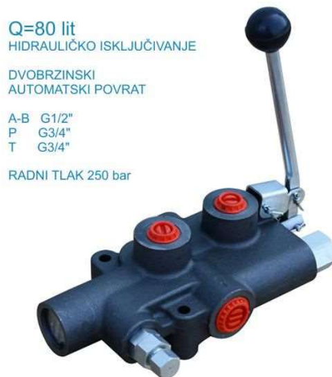
Slika 3-6 Razvodnik „151 Hidrospoj“
