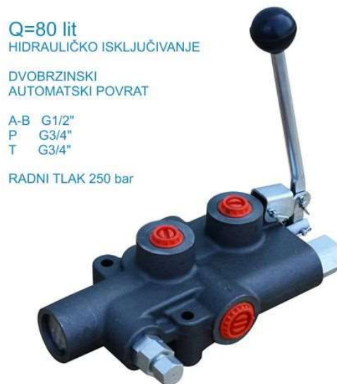
Slika 3-6 Razvodnik „151 Hidrospoj“
