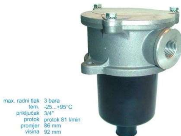
Slika 3-8 Povratni filter od 81 litara
