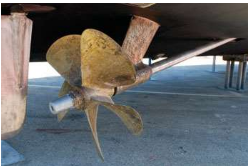
Slika 3.20 Brodski vijak sa vratilom i skrokom, [9]
