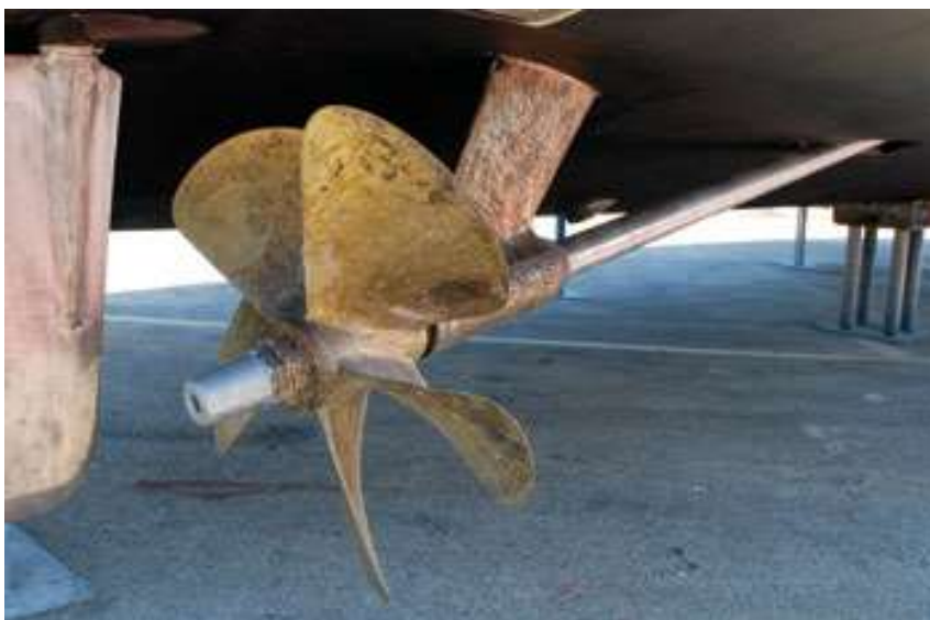
Slika 3.20 Brodski vijak sa vratilom i skrokom, [9]
