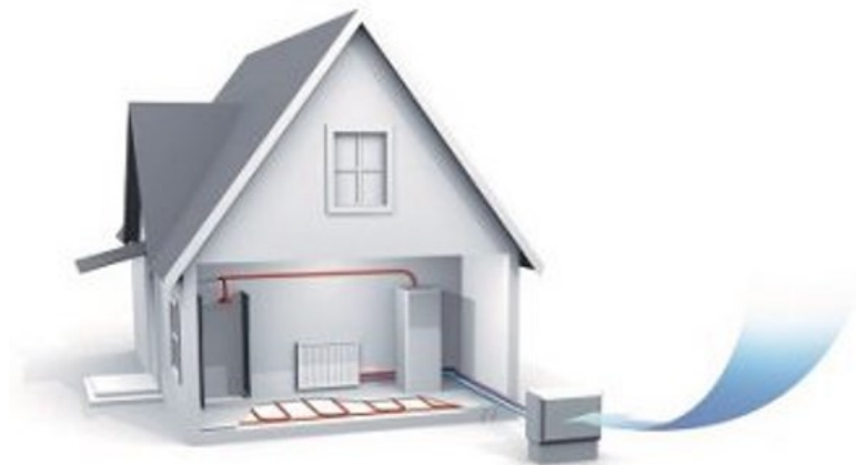
Slika 3.2 Skica ugradnje dizalice topline zrak-voda [7]
