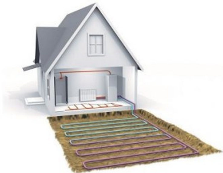
Slika 3.4 Skica ugradnje dizalice topline zemlja-voda [7]
