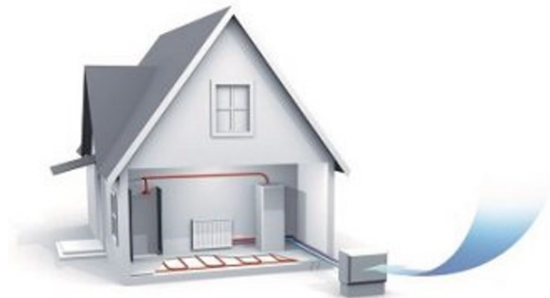
Slika 3.2 Skica ugradnje dizalice topline zrak-voda [7]
