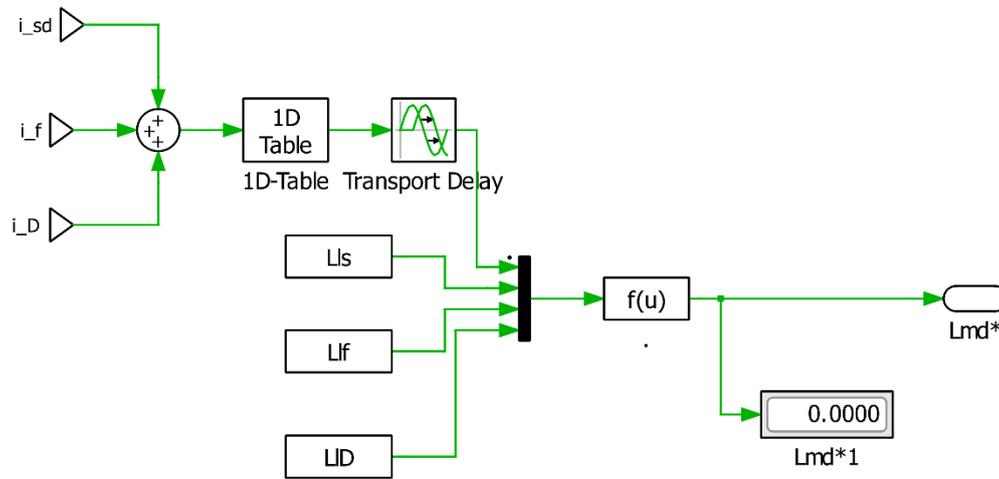
*Slika C-3a Simulacijski prikaz nelinearnog zasićenja u  $d$ -osi*
