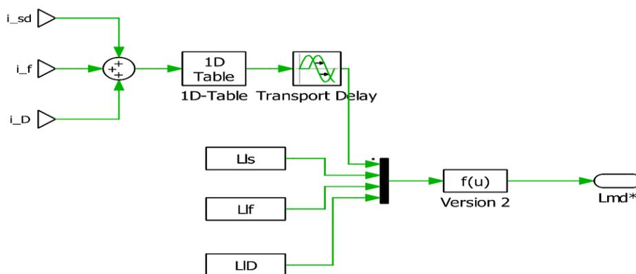
Slika 3.2. Modeliranje zasićenja u d-osi, podsustav (2-69)
