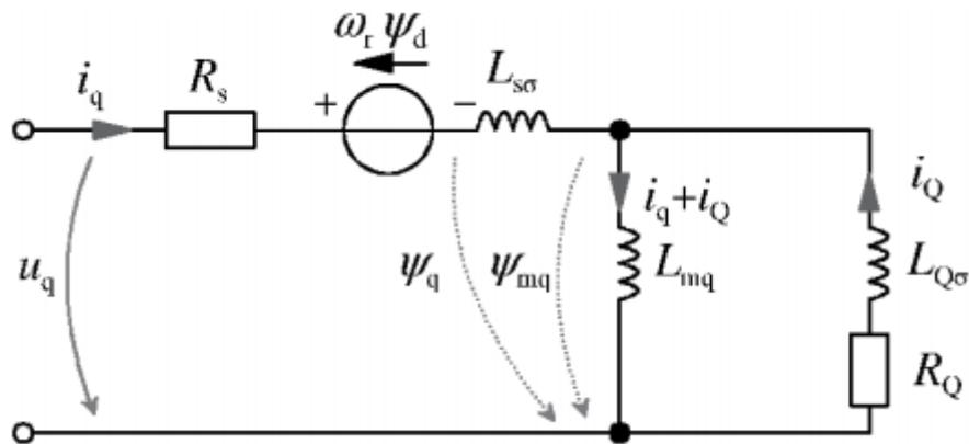
Slika 2.6. Nadomjesna shema sinkronog stroja u q-osi[6]
