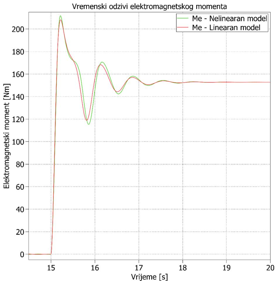
Slika 5.2.2. Vremenski odzivi elektromagnetskog momenta  $m_e$  nelinearnog i linearnog modela sinkronog stroja sa uključanjem tereta u  $t = 15$ [s]
