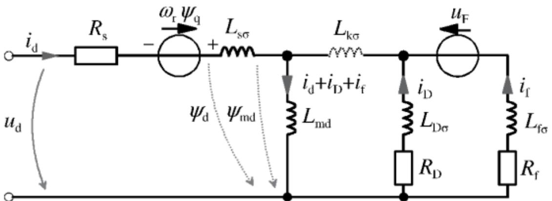
Slika 2.7. Nadomjesna shema sinkronog stroja u d-osi[6]
