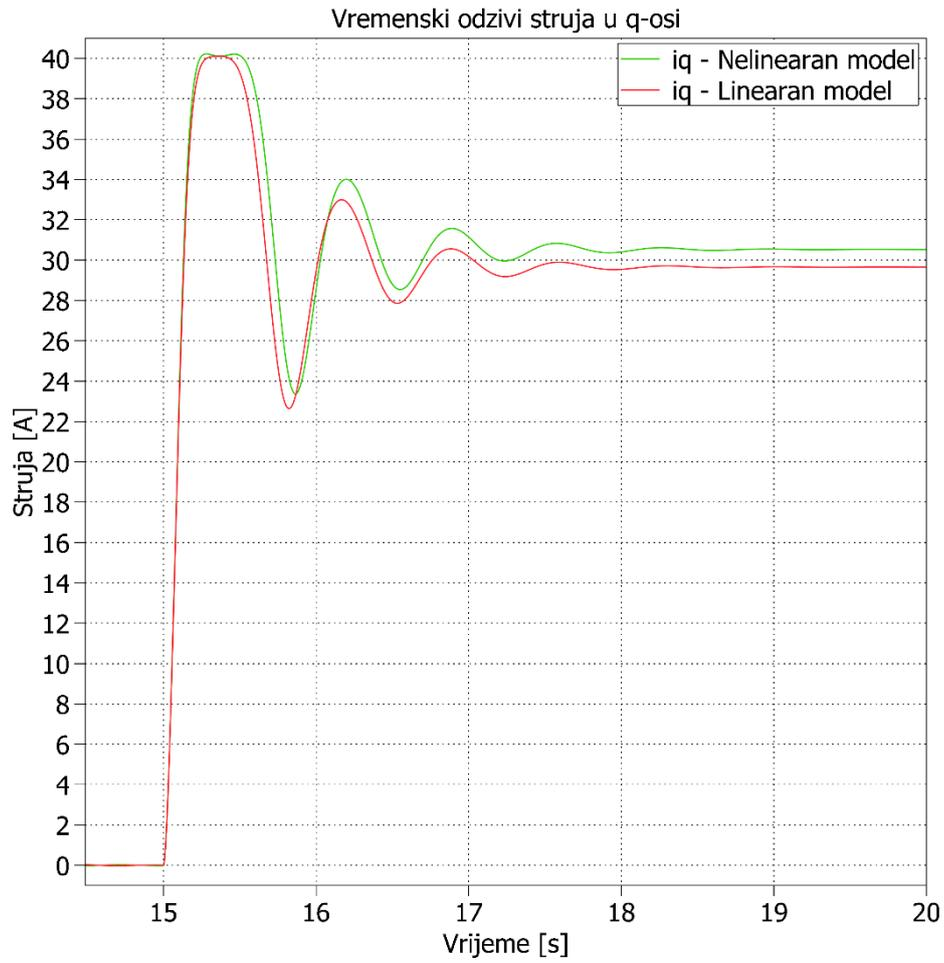
Slika 5.2.4. Vremenski odziv struja u poprečnoj q-osi nelinearnog i linearnog modela sinkronog stroja sa uključenjem tereta u  $t = 15[s]$
