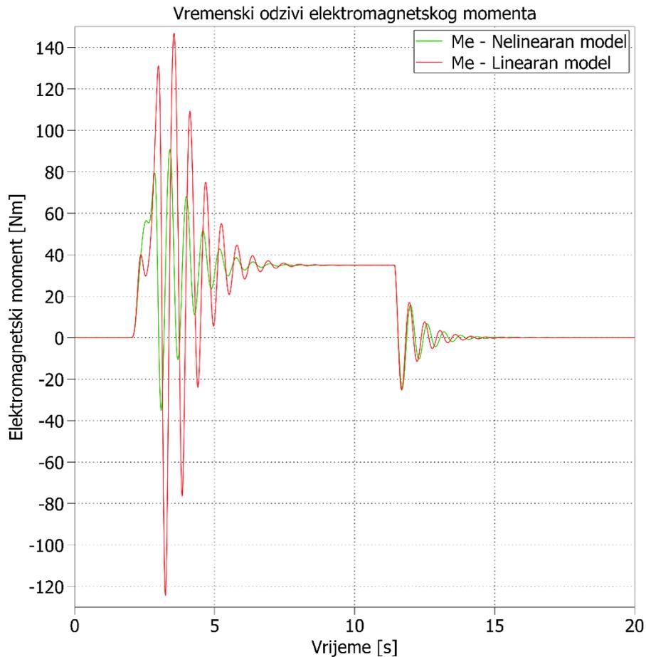
Slika 5.1.2. Vremenski odzivi elektromagnetskog momenta  $m_e$  nelinearnog i linearnog modela sinkronog stroja bez uključenja momenta tereta
