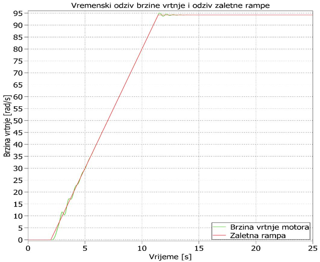
Slika 4.5. Pravac V/f rampe i zaleta motora
