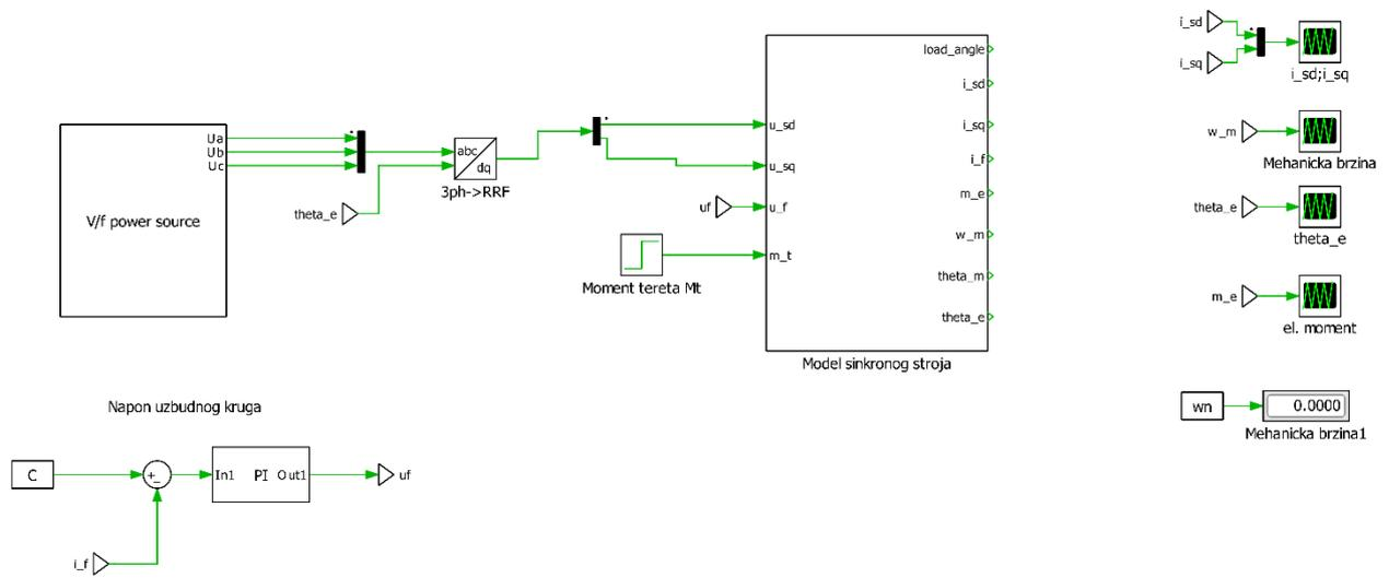
Slika C.1 Simulacijski prikaz modela sinkronog stroja u programu PLECS
