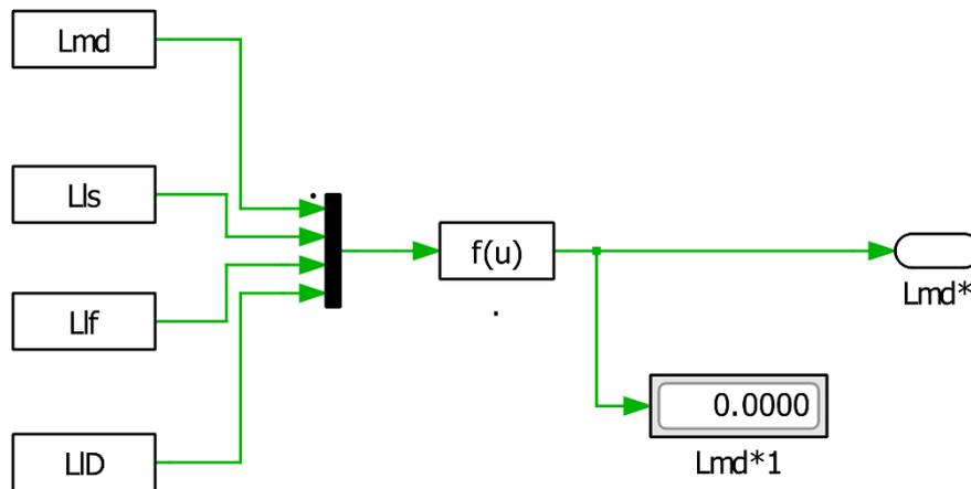
*Slika C-3b Simulacijski prikaz linearnog zasićenja u  $d$ -osi*
