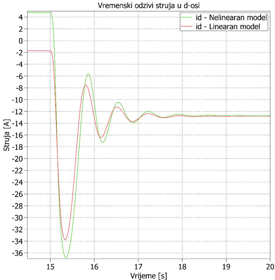
Slika 5.2.3. Vremenski odziv struja u uzdužnoj  $d$ -osi nelinearnog i linearnog modela sinkronog stroja sa uključanjem tereta u  $t = 15[s]$
