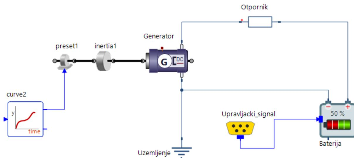
Slika 7.9 – Simulacijski model regenerativnog kočenja za električno vozilo
