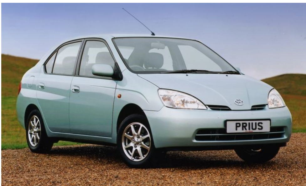
Slika 2.4 - Toyota Prius iz 1997. s hibridnim pogonom [8]
