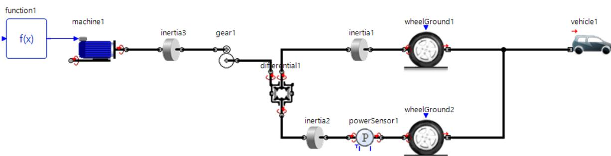
Slika 6.1 – Simulacijski model vožnje korištenjem elektromotora
