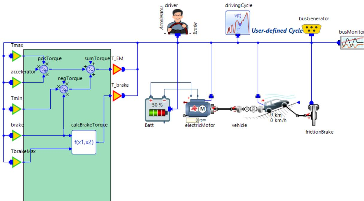
Slika 7.11 – Simulacijski model cjelokupnog električnog vozila [31]
