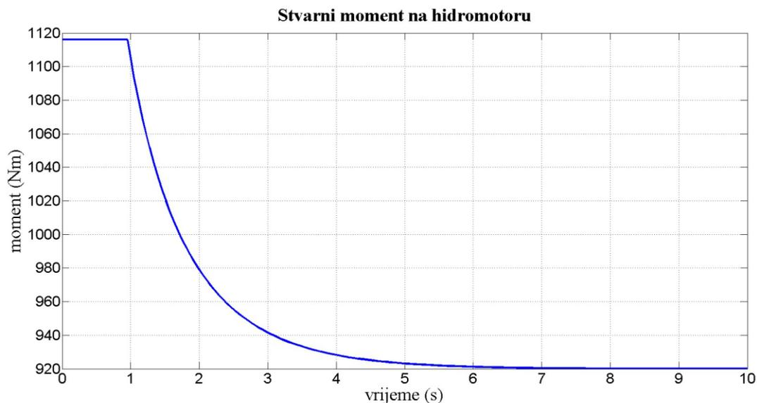
Slika 7.4 - Stvarni moment na hidromotoru tijekom kretanja vozila (prethodni rad) [4]
