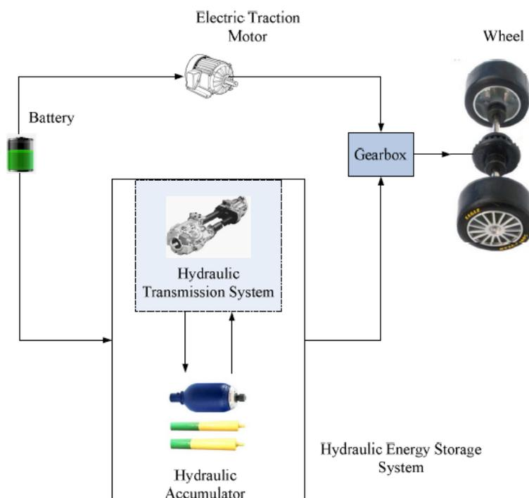
Slika 4.3 – Shematski prikaz hidrauličkog električnog hibridnog vozila [19]
