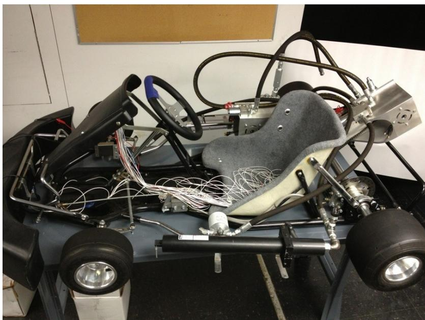
Slika 4.1 – Testno *go-kart* hidrauličko električno hibridno vozilo [15]
