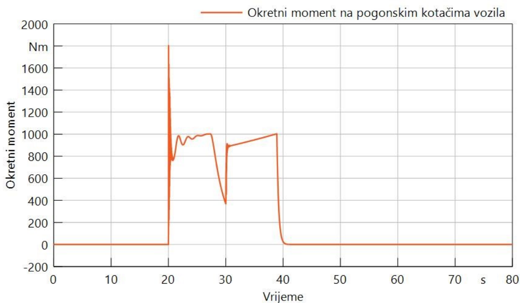
Slika 6.31 - Graf ovisnosti okretnog momenta pogonskih kotača za slučaj dvostrukog ubrzavanja o vremenu simulacije
