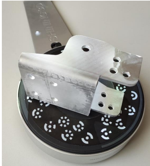
Slika 5.3. Prikaz elementa 1 s tankim slojem bijelog praha
