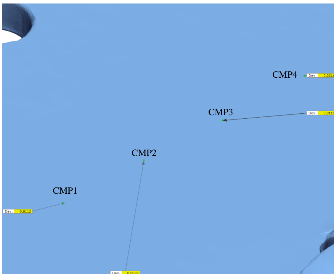
Slika 7.12. Odstupanje elementa 2 na velikim i ravnim površinama
