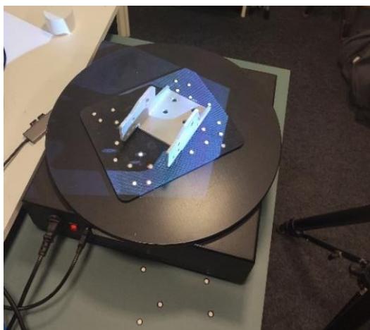
Slika 6.6. Element 2 skeniran u drugom položaju
