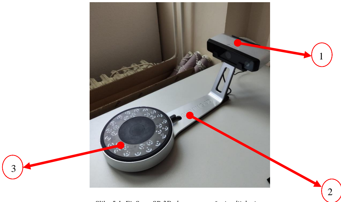
Slika 5.1. EinScan-SP 3D skener s označenim dijelovima
