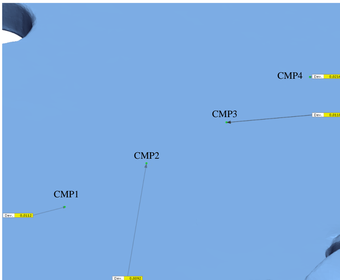
Slika 7.12. Odstupanje elementa 2 na velikim i ravnim površinama
