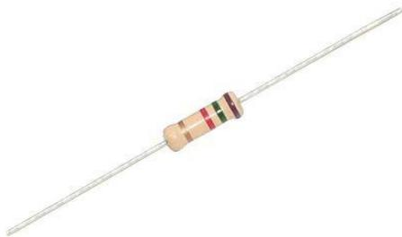
Slika 3.4. Otpornik od 500 Om-a [9].
