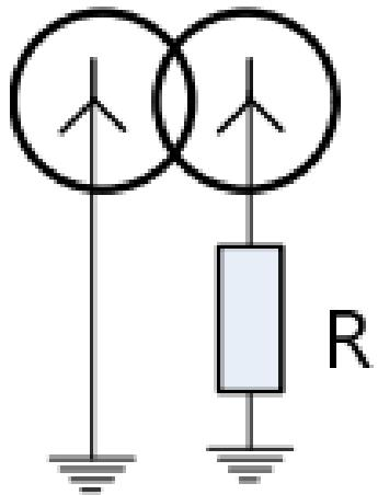
*Slika 6.3. Uzemljenje transformatora preko maloomskog otpornika*
