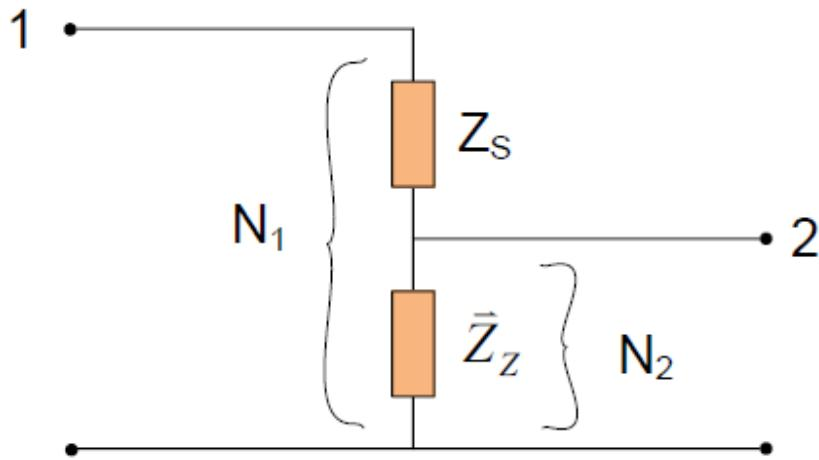
*Slika 5.10. Nadomjesni model autotransformatora*
