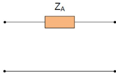
*Slika 5.12. Jednofazni nadomjesni model dvonamotnog autotransformatora*
