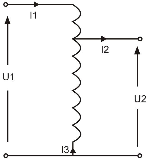
Slika 4.1. Shema autotransformatora
