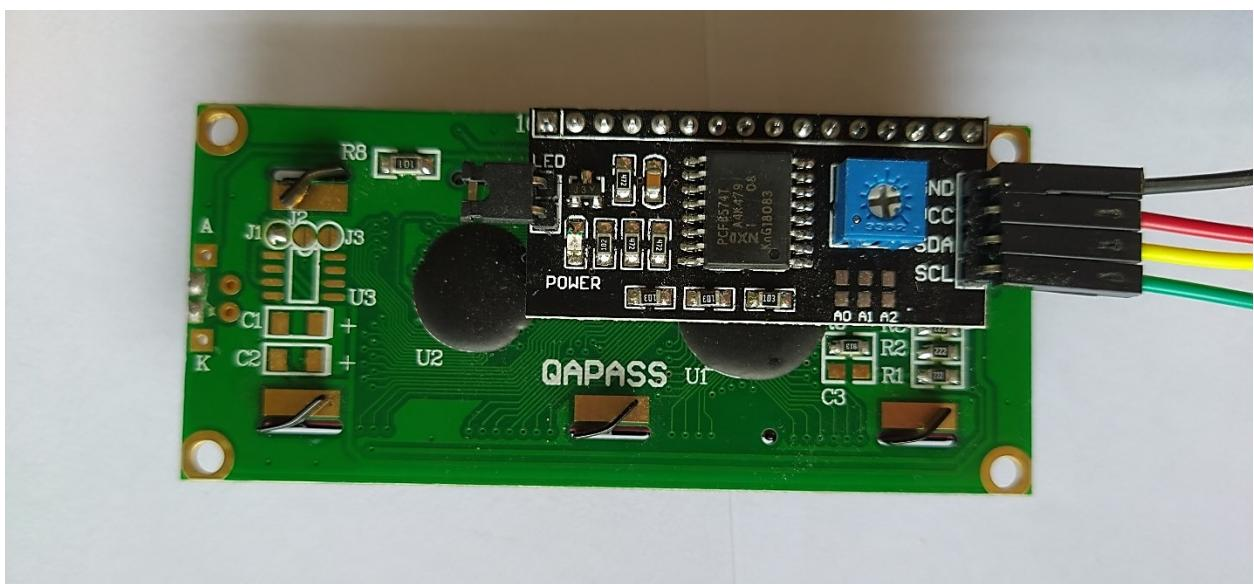
Slika 3.9. I<sup>2</sup>C adapter ugrađen na pozadini LCD 16x2 zaslona
