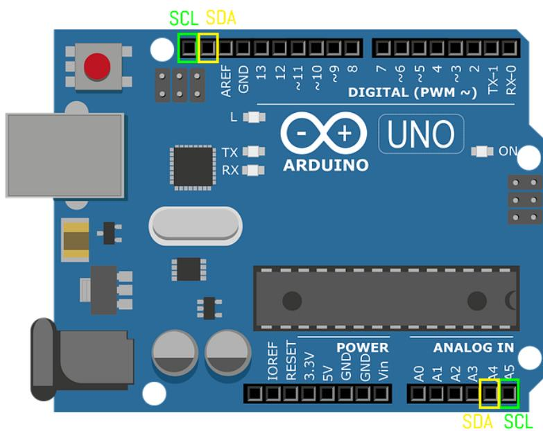
Slika 2.4. Model Arduino Uno pločice s označenim pinovima za uspostavu I<sup>2</sup>C komunikacije [14]
