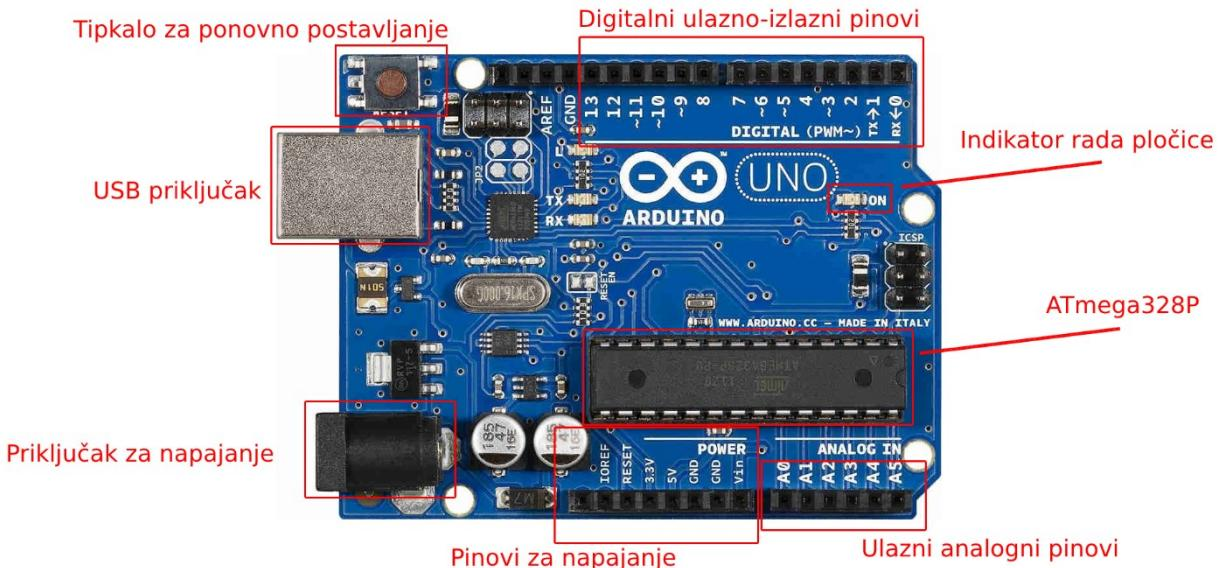
Slika 2.1. Sklopovlje Arduino Uno R3 elektroničke pločice [4]
