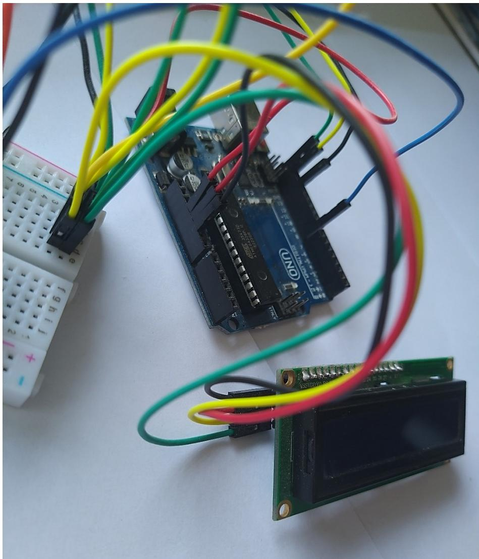
*Slika 4.4. Povezivanje LCD 16x2 zaslona s I<sup>2</sup>C adapterom s Arduinom pomoću eksperimentalne pločice*
