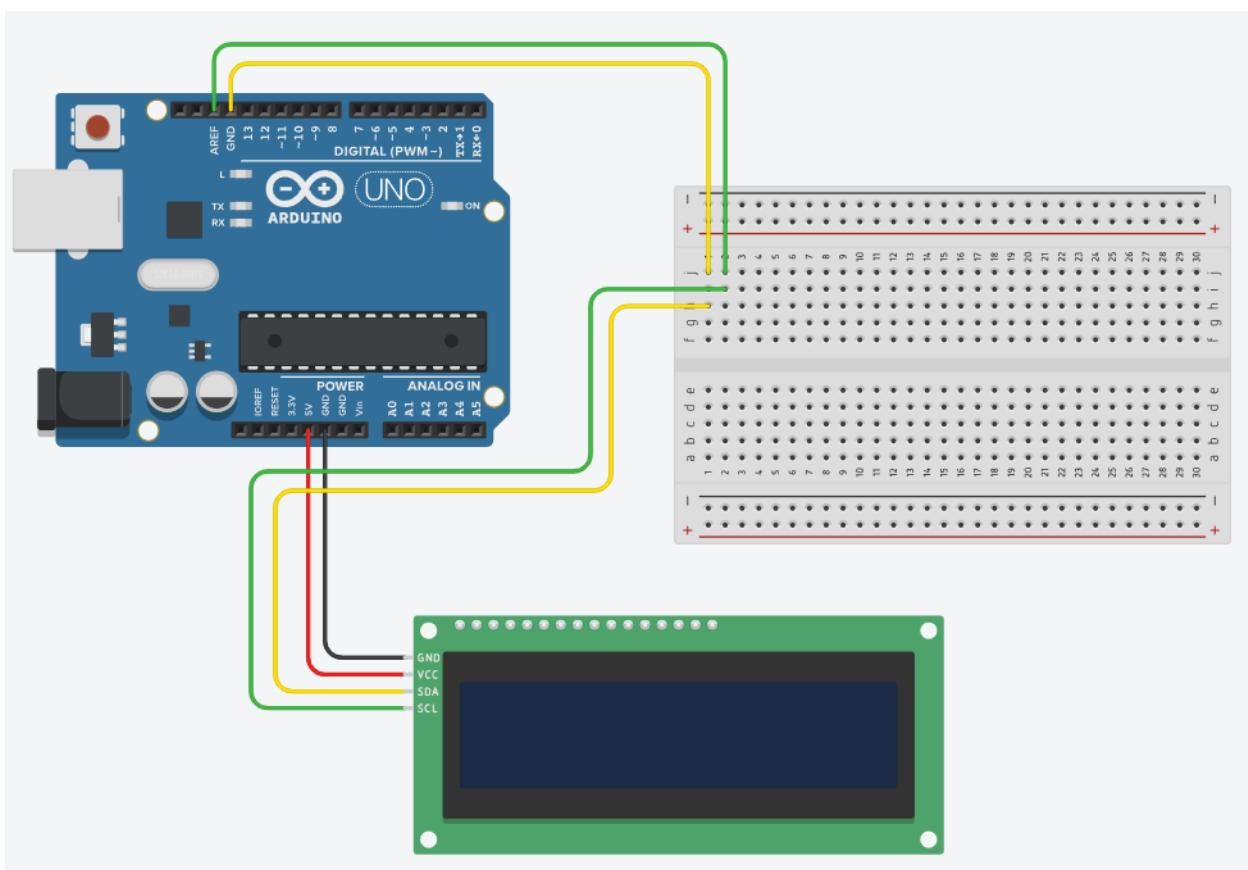
Slika 4.3. Shema spajanja LCD 16x2 zaslona s I<sup>2</sup>C adapterom izrađena u aplikaciji TinkerCad
