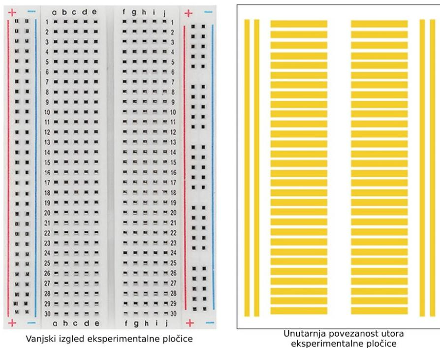
Slika 3.1. Vanjski i unutarnji izgled eksperimentalne pločice [25]
