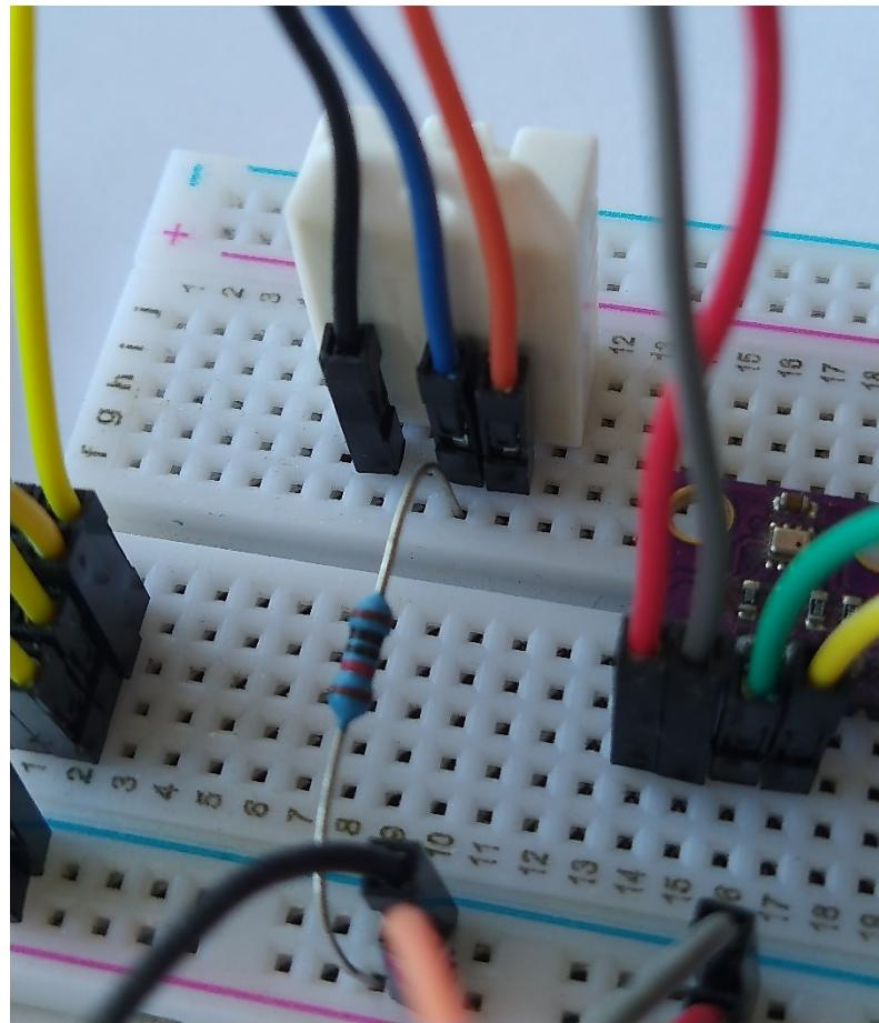
Slika 4.17. Prikaz modula DHT22 spojenog na eksperimentalnu pločicu
