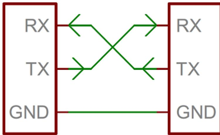
Slika 2.2. Blok shema UART komunikacije između dva uređaja [7]
