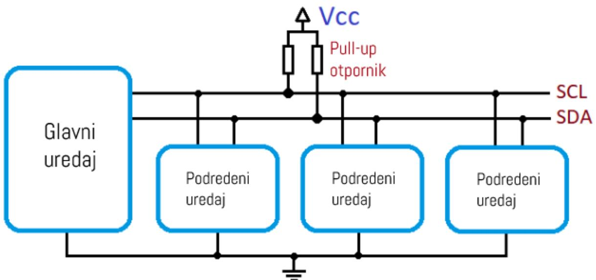
Slika 2.5. Blok shema uspostavljanja I<sup>2</sup>C komunikacije između više uređaja [15]
