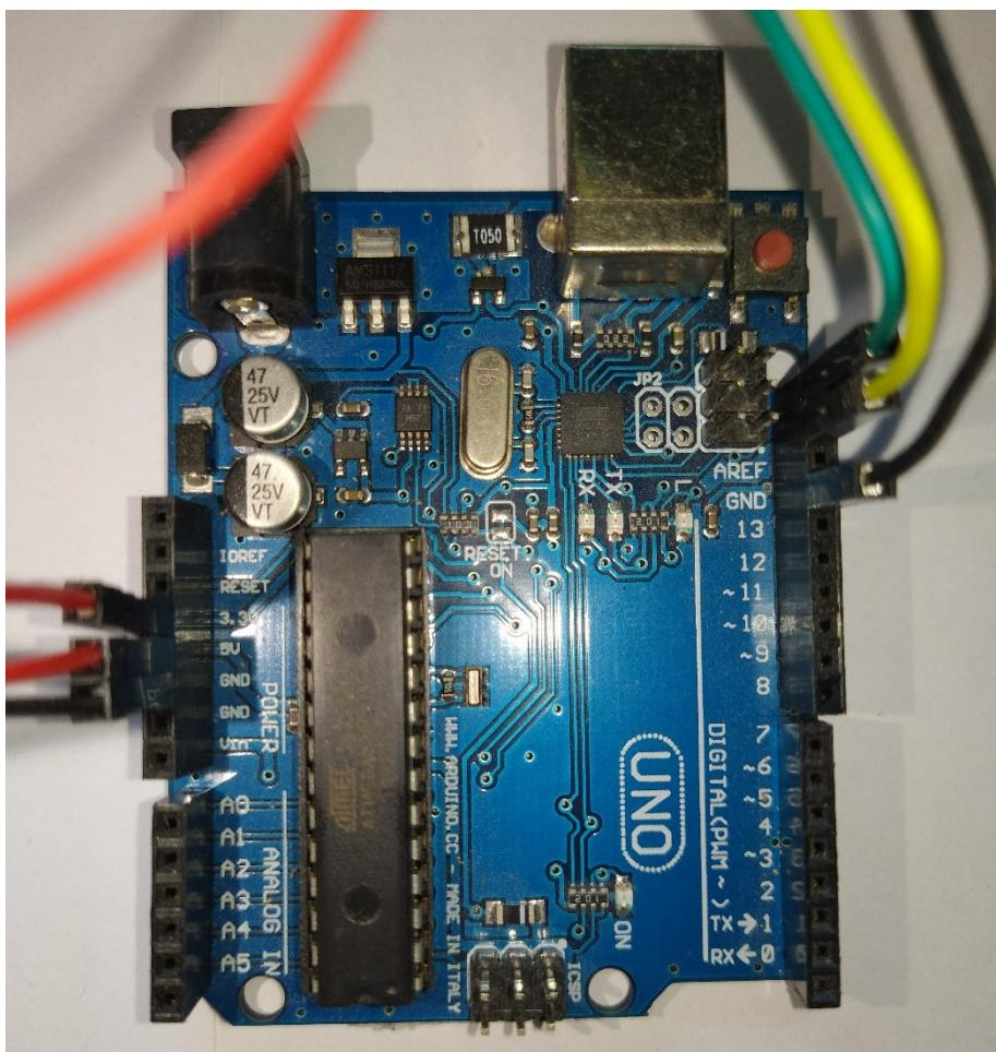
Slika 4.1. Izgled Arduino Uno R3 pločice nakon spajanja vodiča na I<sup>2</sup>C ulaze te na ulaze za napajanje i masu
