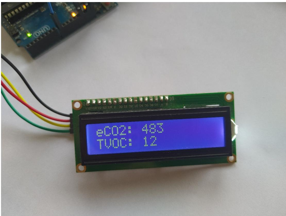
Slika 4.15. Ispis eCO<sub>2</sub> i TVOC vrijednosti na LCD 16x2 zaslonu 5 minuta nakon uključenja
