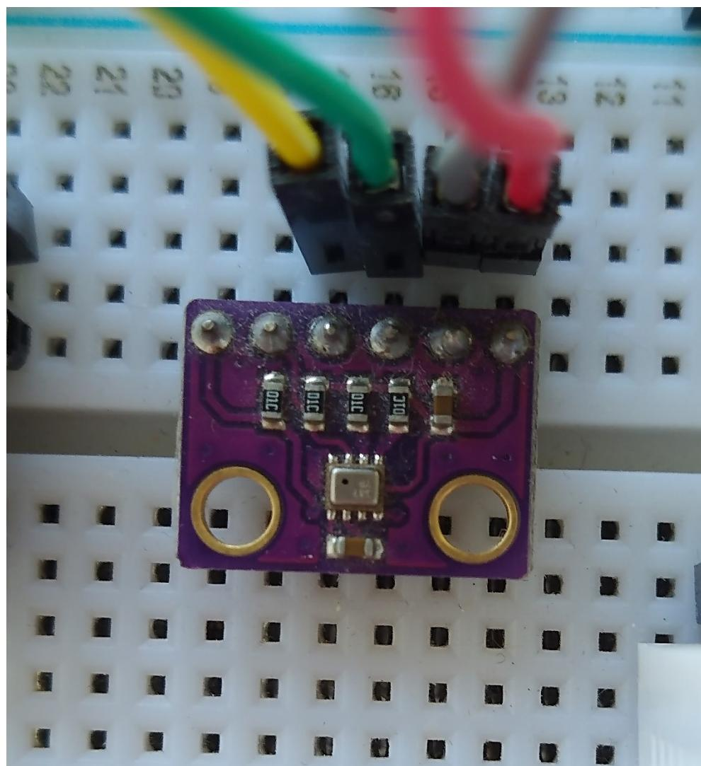
Slika 4.7. Prikaz modula GY-BMP280 spojenog na eksperimentalnu pločicu
