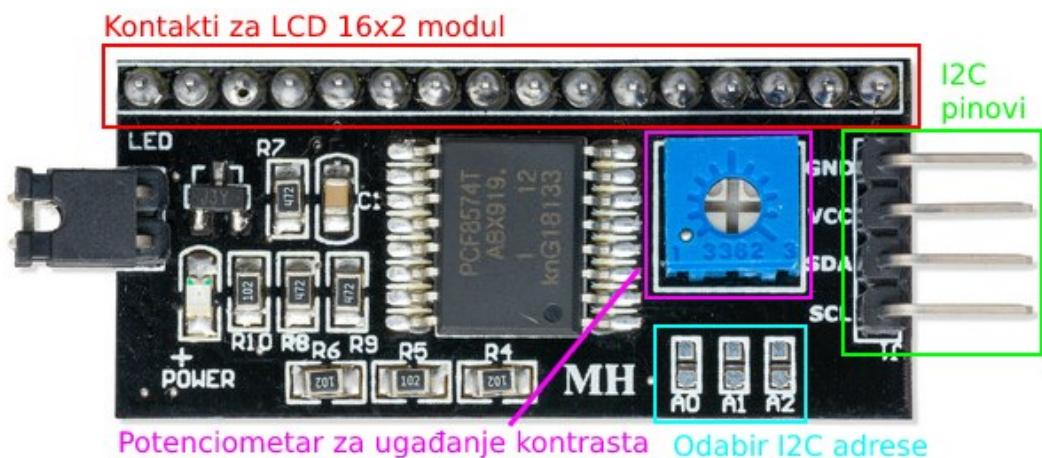
Slika 3.8. I<sup>2</sup>C adapter za LCD 16x2 zaslon [40]
