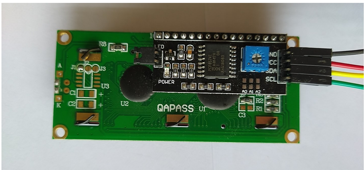
Slika 3.9. I 2 C adapter ugrađen na pozadini LCD 16x2 zaslona
