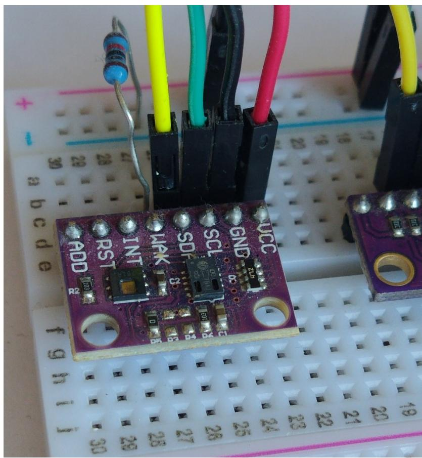
Slika 4.13. Prikaz modula CJMCU-811 spojenog na eksperimentalnu pločicu
