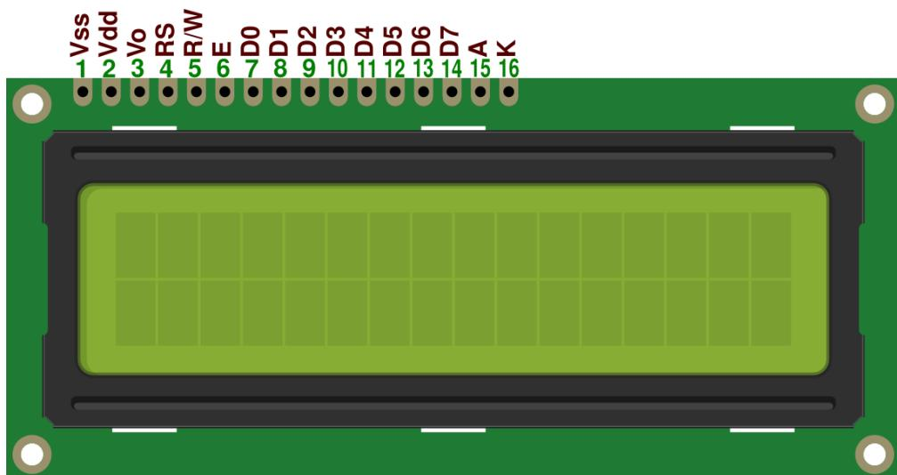
Slika 3.7. LCD 16x2 zaslon s HD44780 kontrolerom [39]
