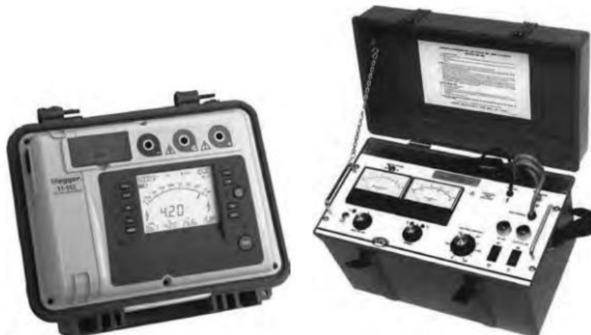
Slika 3.1. Električni megaommetar, 5000 V (lijevo) i istosmjerni dielektrični testni set, 15 kV (desno) [1]
