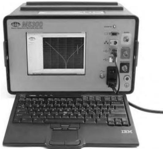
Slika 3.10. Instrument za ispitivanje frekvencijskog odziva M5300 [1]
