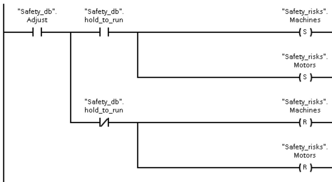
Slika 5.8. Pokretanje i zaustavljanje uređaja. U slučaju ovog zadatka, isključen je izbor pokretanja hidraulike i pneumatike.
