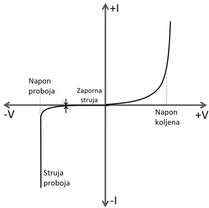
Slika 5.5. Strujno-naponska karakteristika diode [11]
