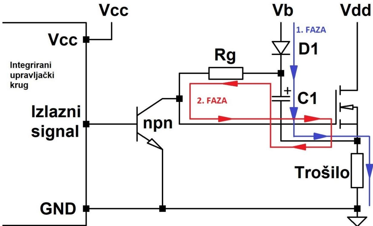
Slika 5.14. Princip rada tehnike kondenzatora plutajućeg potencijala
