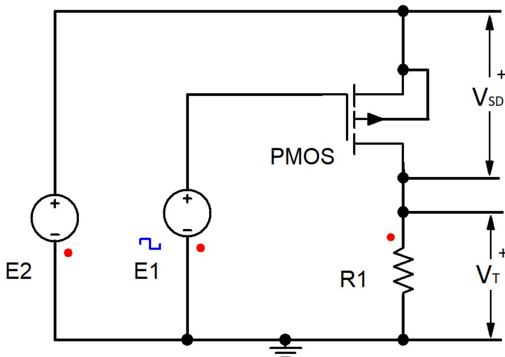
Slika 5.13.b. Shema simulacije sklapanja trošila pomoću p-kanalnog MOSFET-a
