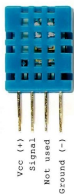
Slika 5.2. Raspored pinova DHT11 senzora
