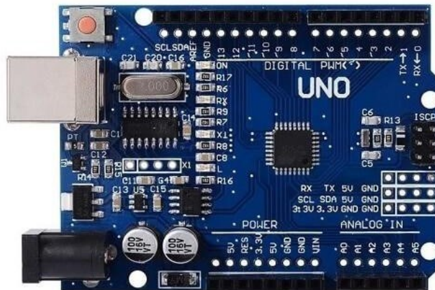
Slika 3.3. Ploča Arduino Uno SMD R3
