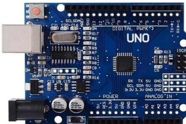
Slika 3.3. Ploča Arduino Uno SMD R3
