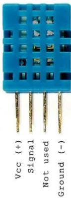
*Slika 5.2. Raspored pinova DHT11 senzora*
