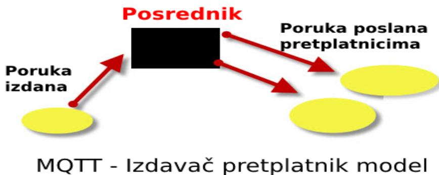
*Slika 7.1. MQTT - Izdavač preplatnik model*
