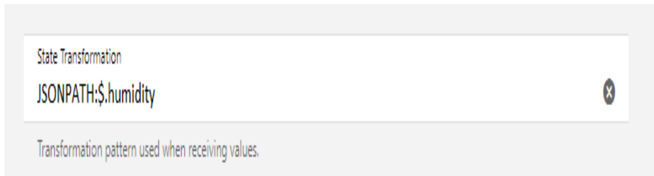
Slika 8.9.. Transformacija Stanja za vlažnost zraka
