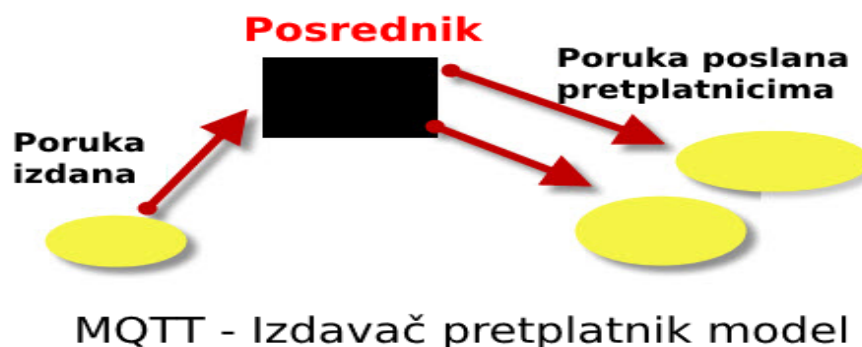
Slika 7.1. MQTT - Izdavač pretplatnik model
