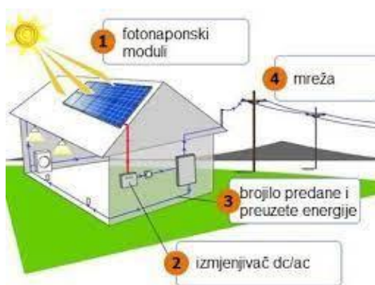
Slika 5.1 Mrežni fotonaponski sustav [10]
