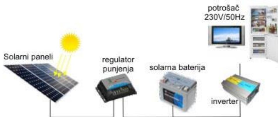
Slika 5.2 Otočni fotonaponski sustav [9]
