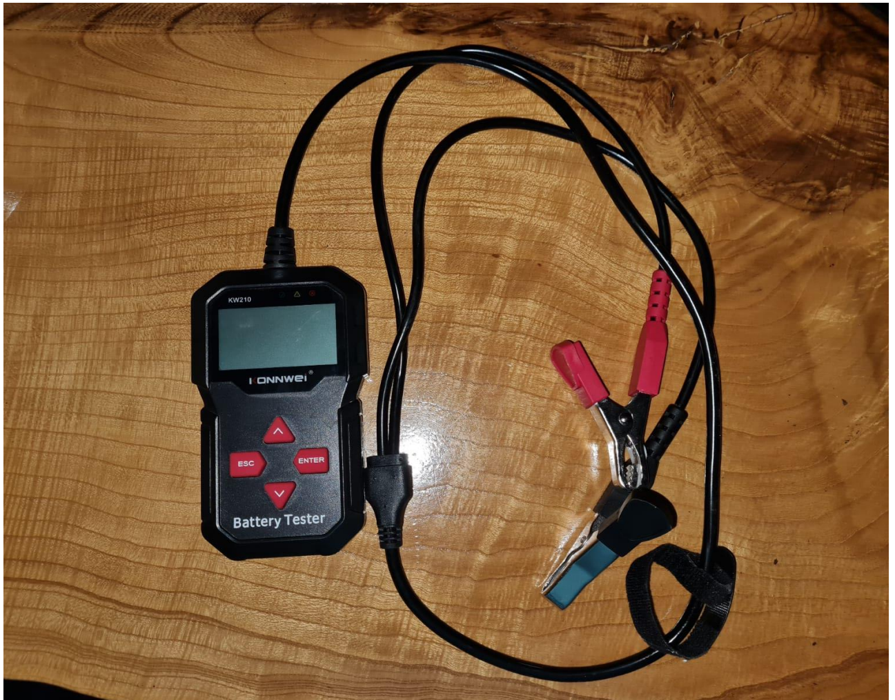
Slika 9.2. Digitalni analizator stanja baterije ( Battery tester )
