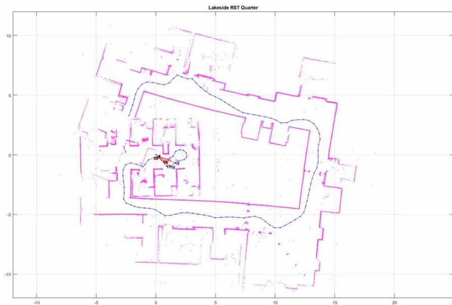
Slika 2.2: Primjer akumuliranja pogrešaka u pronalaženju položaja [2]
