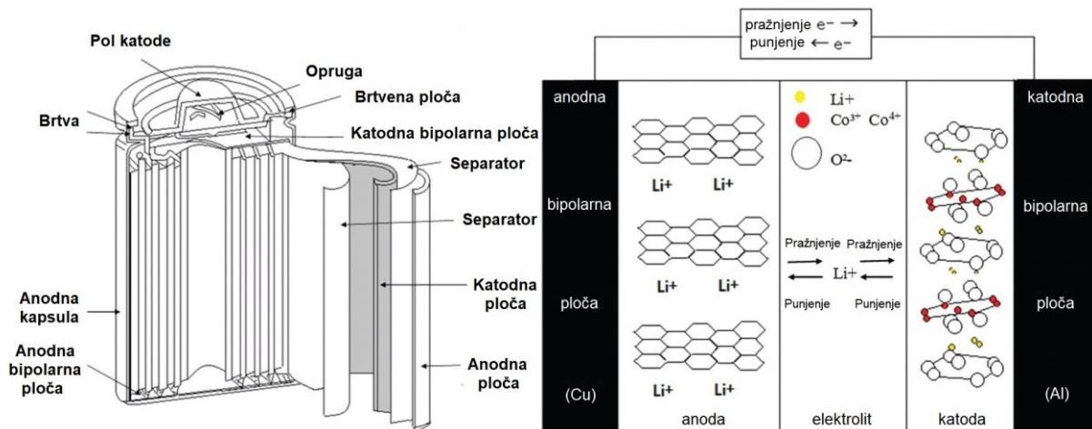
Slika 3.5. Presjek i princip rada Li-ion baterijskog članka (baterije) [28]
