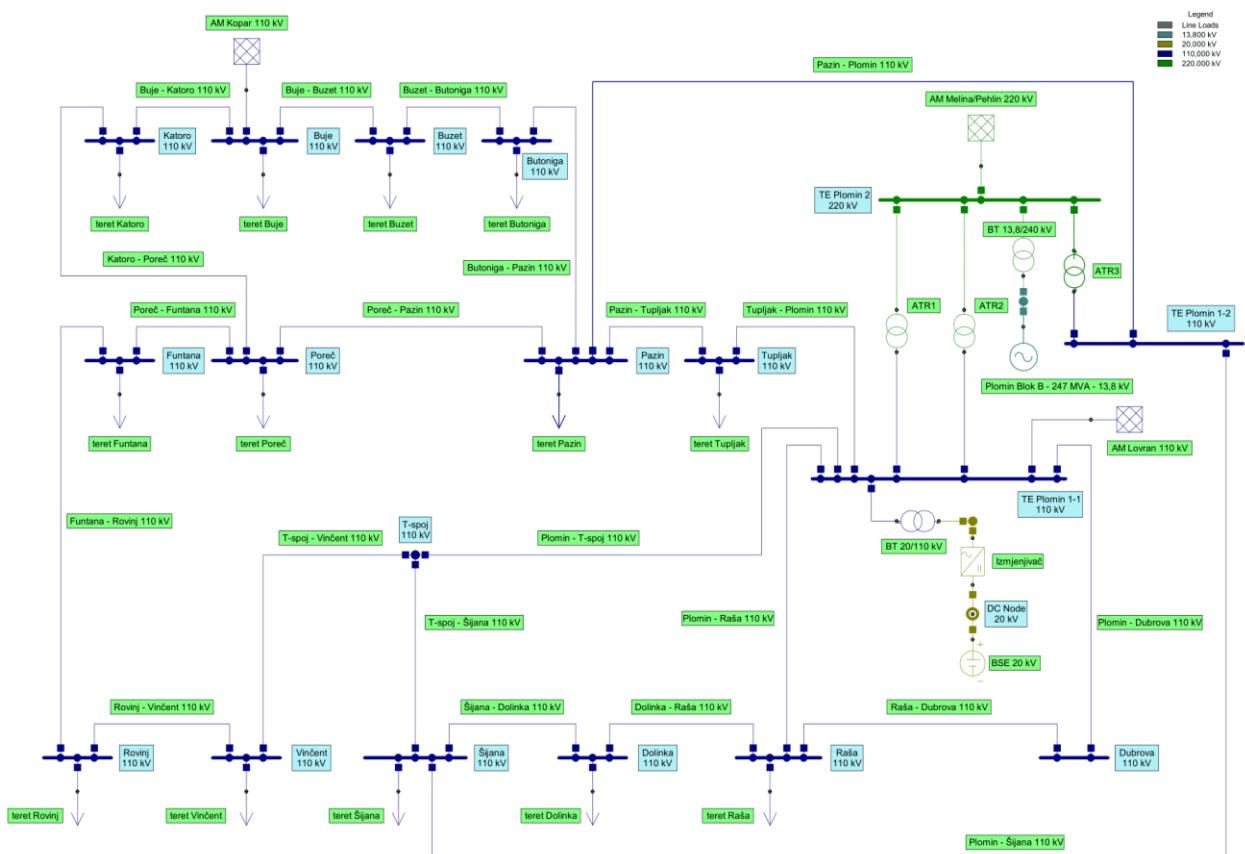
Slika 5.2. Modelirani elektroenergetski podsustav Istre u NEPLAN-u
