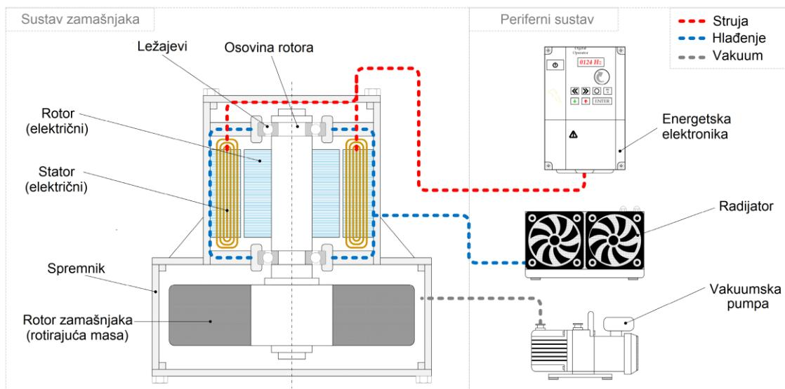
Slika 2.5. Shematski prikaz sustava zamašnjaka [10]
