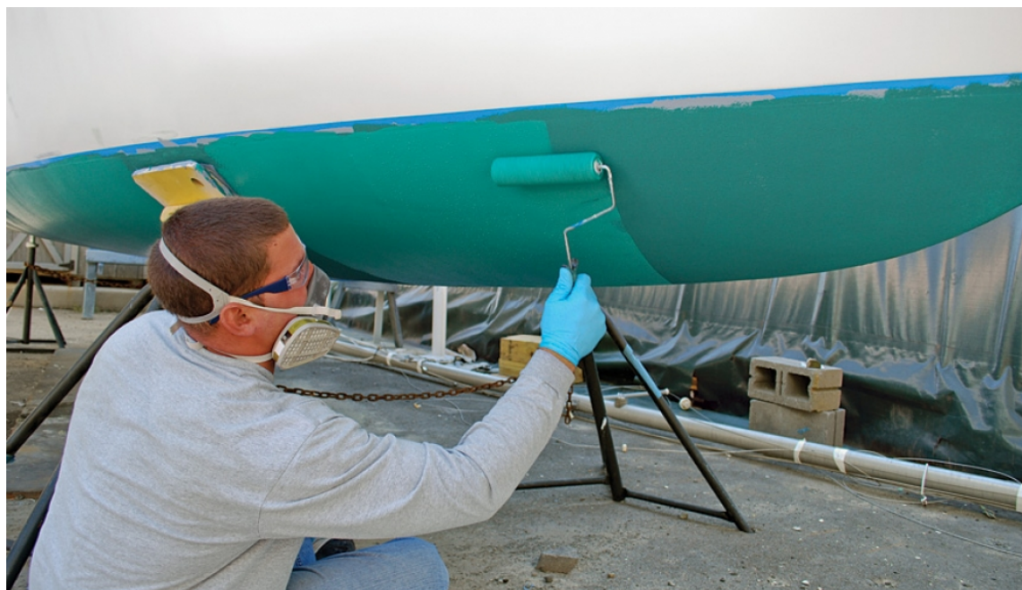
Slika 3.7.1.1.: Postavljanje antivegetativne zaštite na trup jedrilice
