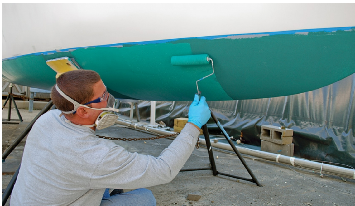
Slika 3.7.1.1.: Postavljanje antivegetativne zaštite na trup jedrilice
