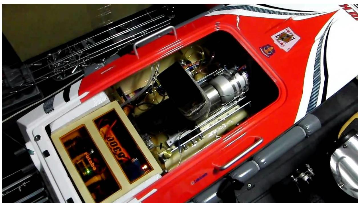
*Slika 3.3 Prikaz turbine ugrađene u plovilo*
