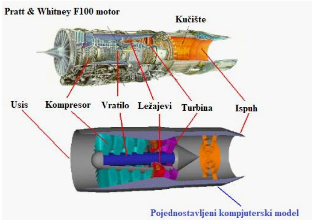
*Slika 2.1 Dijelovi plinske turbine*
