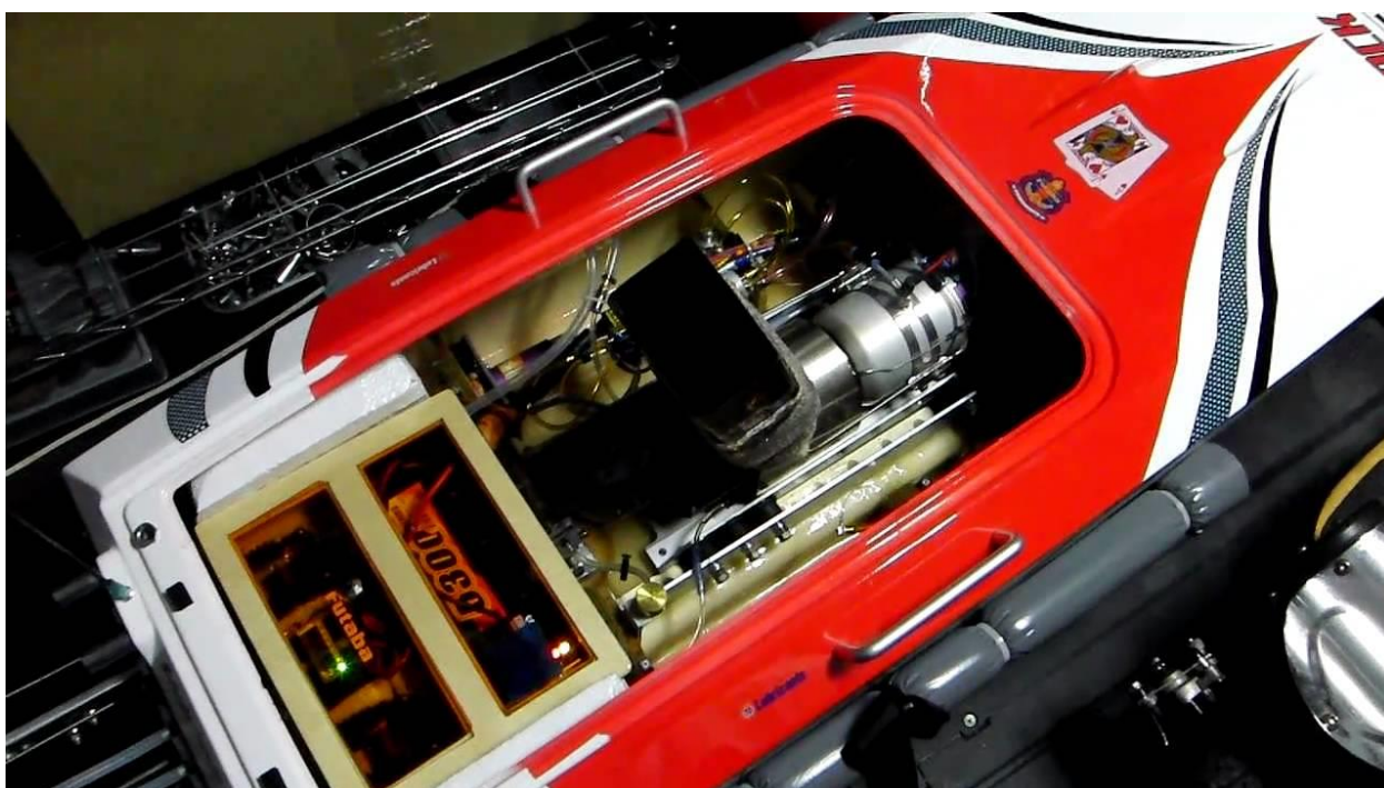
Slika 3.3 Prikaz turbine ugrađene u plovilo
