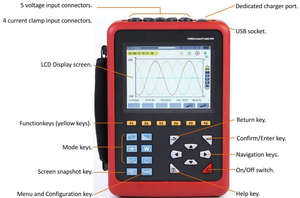
Slika 4.3. Izgled uređaja UNI-T UT285C[16]
