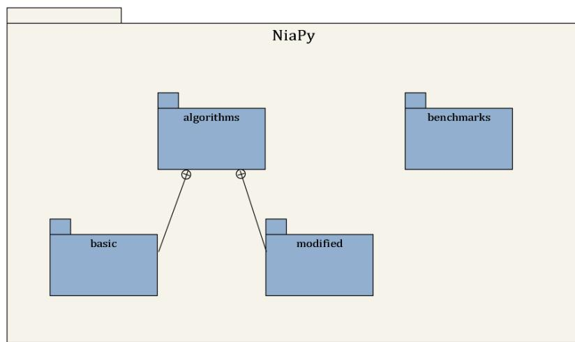
Slika 4.6 Pojednostavljeni dijagram strukture NiaPy razvojnog okvira
