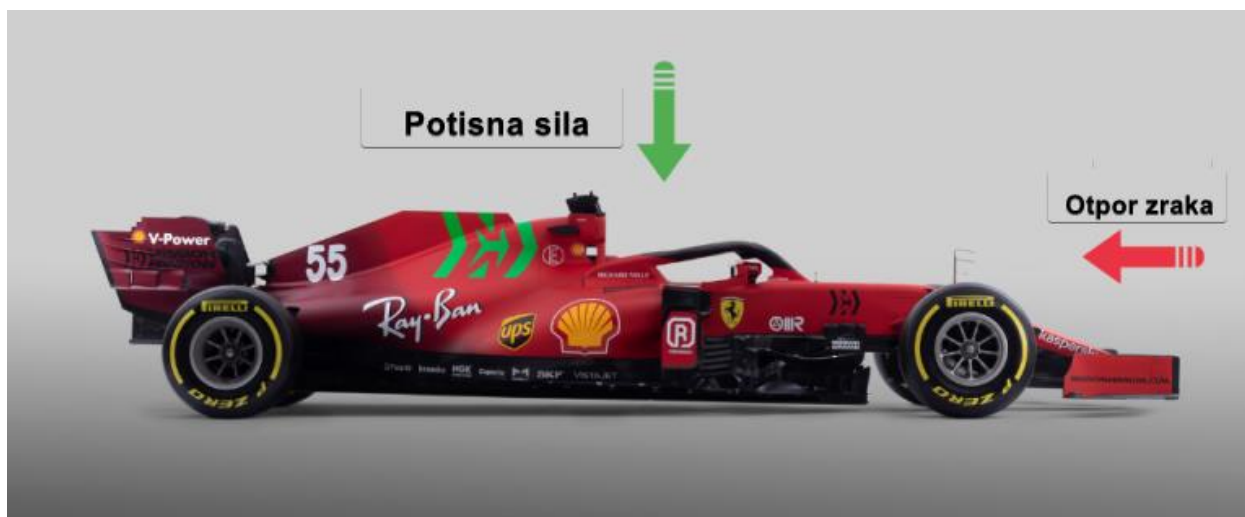
Slika 3.5. Smjer djelovanja potisne sile i otpora zraka [25]
