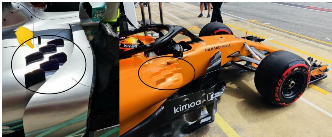
Slika 3.19. Generatori vrtloga kod Formule 1 [37]
