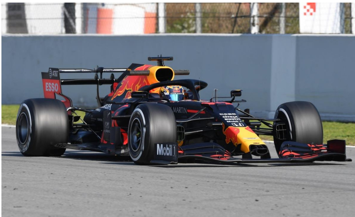
Slika 3.22. Automobil Formule 1 s aktiviranim DRS-om [40]
