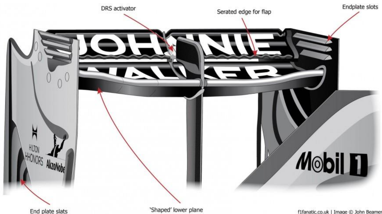
Slika 3.11. Ilustracija stražnjeg krila McLaren tima [30]
