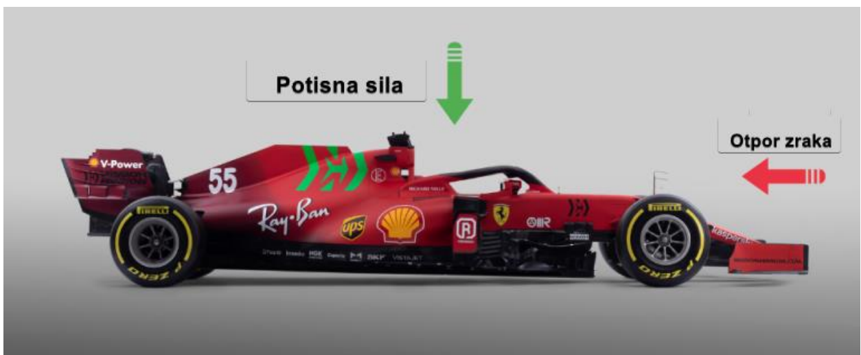
Slika 3.5. Smjer djelovanja potisne sile i otpora zraka [25]
