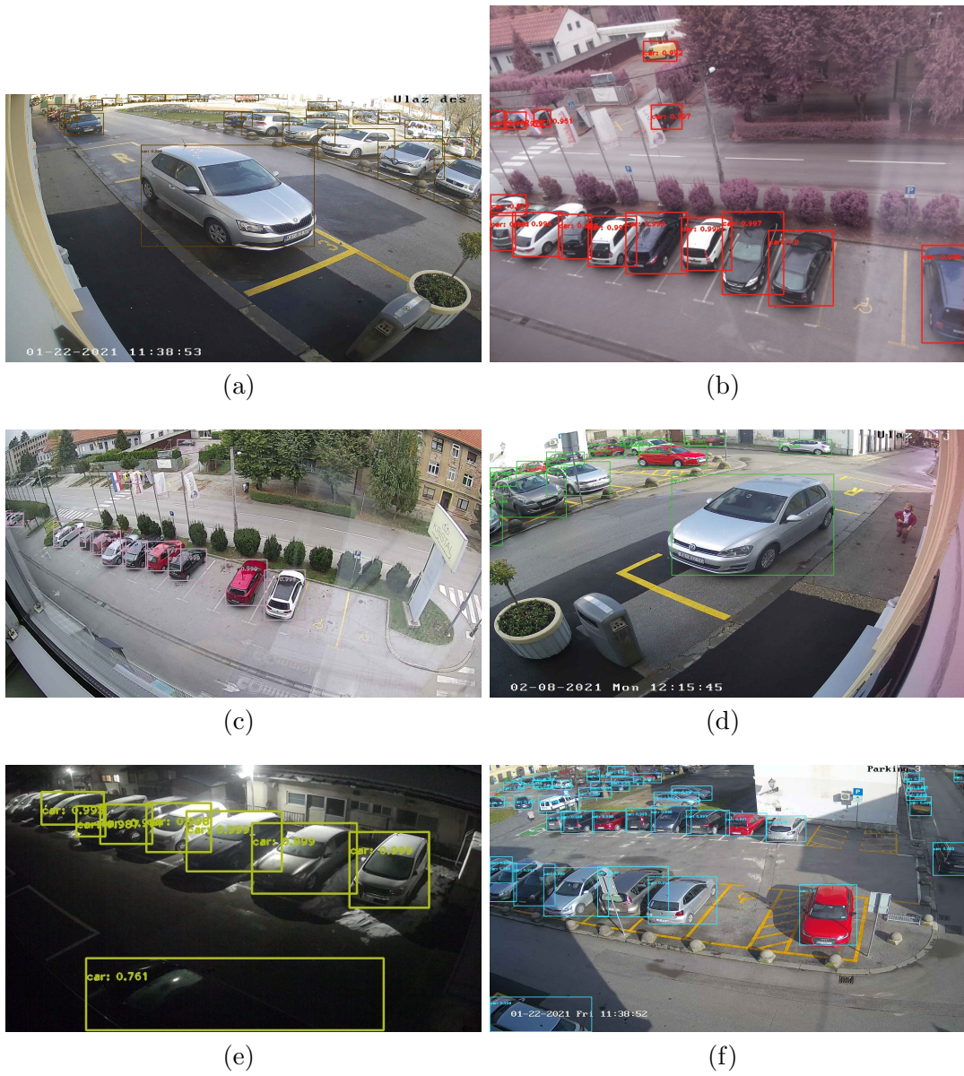
Slika 4.9 Detekcija YOLOv4 modela na testnom setu podataka
