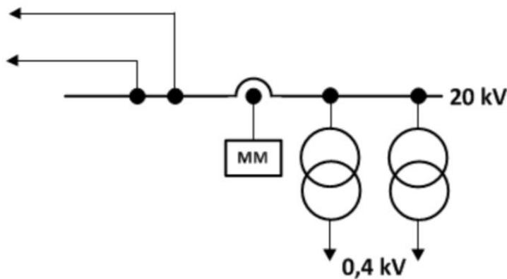
Slika 4.9. Prikaz kabelske izvedbe (KTS) s mjeranjem na SN. Izvor: [6]
