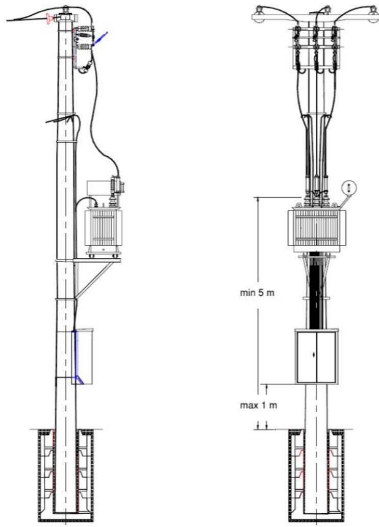
*Slika 4.4. Prikaz izvedbe „stupne“ transformatorske stanice. Izvor: [1]*
