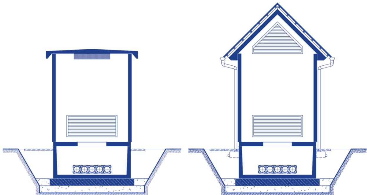
*Slika 4.11. Primjer izvedbe montažne transformatorske stanice z ravним krovom (lijevo) i nagibnim krovom (desno). Izvor: [7]*
