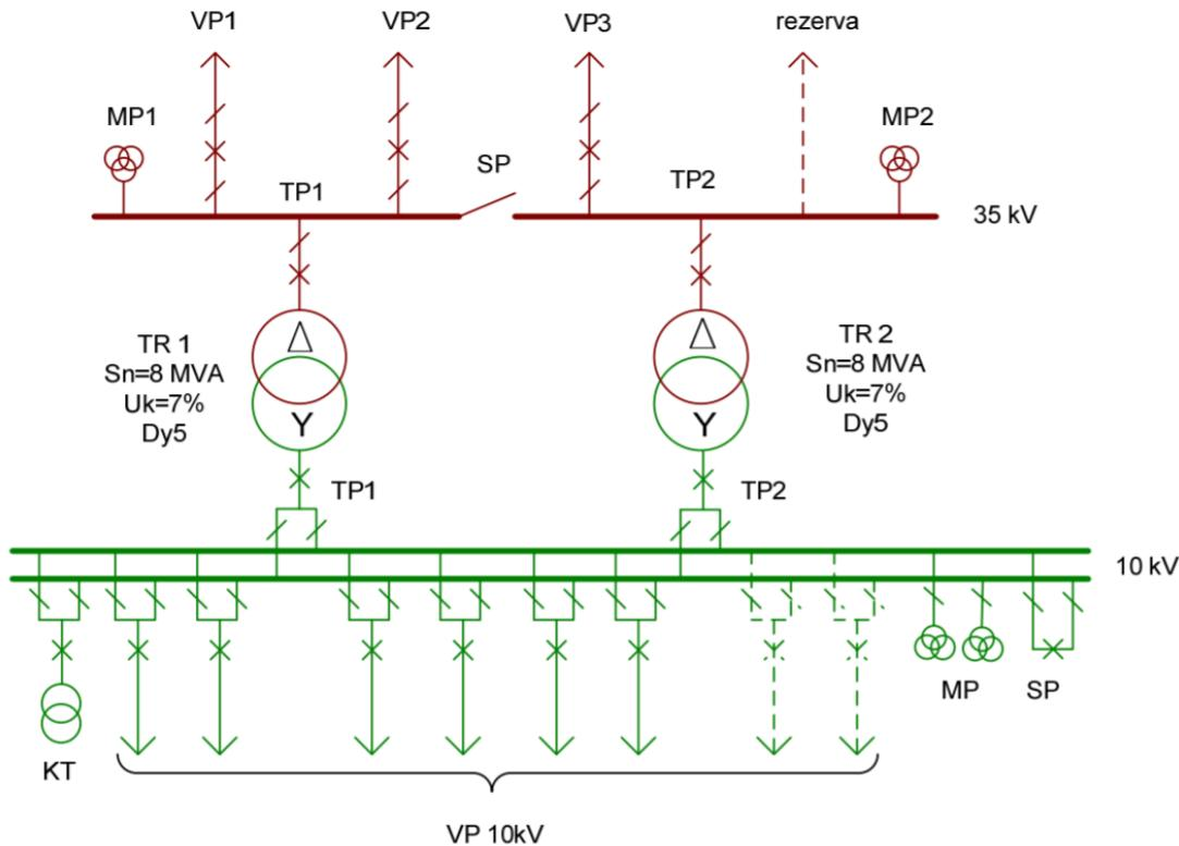
*Slika 4.2. Prikaz izvedbe transformatorske stanice 35/10(20) kV. Izvor: [1]*
