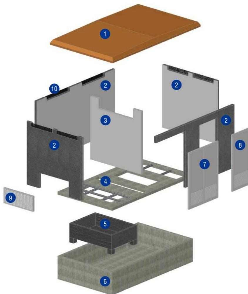
Slika 4.10. Prikaz konstrukcije montažne transformatorske stanice. Izvor: [7]
