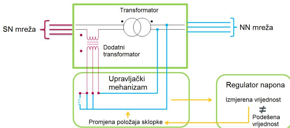
Slika 6.3. Prikaz postupka regulacije s prekidačima na NN strani i dodatnim transformatorom. Izvor: [8]
