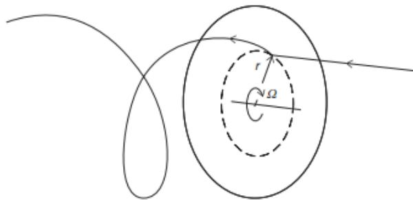
Slika 2.10. Trajektorija gibanja zraka u modelu rotirajućeg diska [6]
