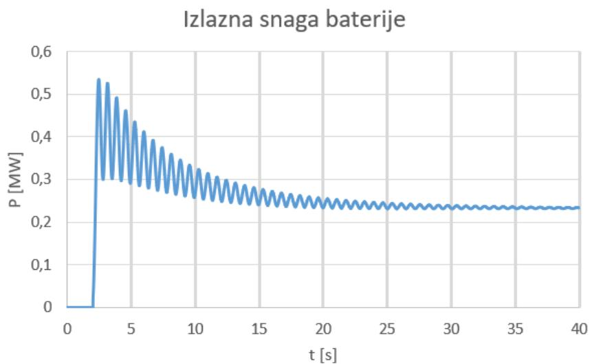
Slika 6.19. Izlazna snaga baterije pri ispadu vjetroelektrane
