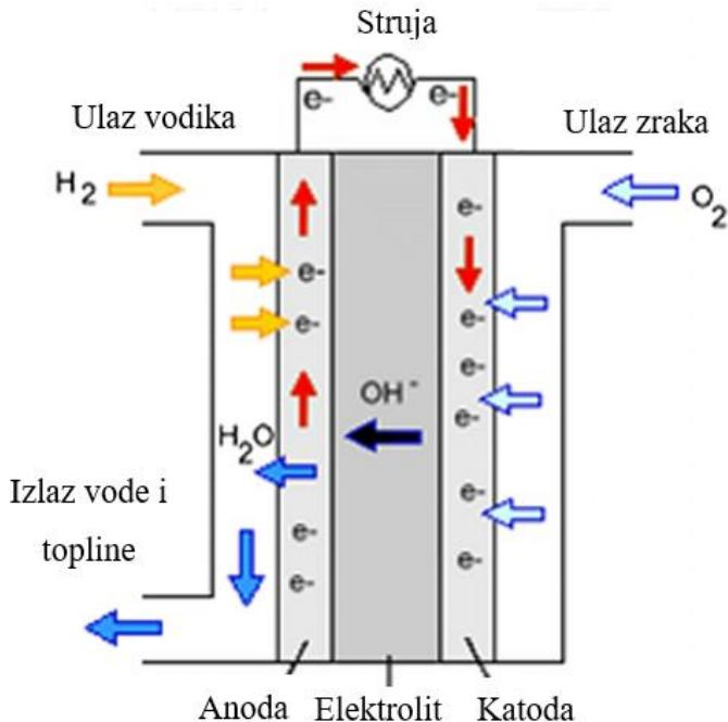
Slika 3.5. Shematski prikaz gorivne ćelije s alkalnim elektrolitom [21]
