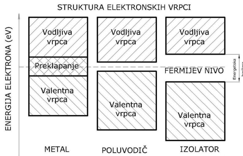
Slika 2.. Energetski pojas ovisan o vrsti materijala [4]
