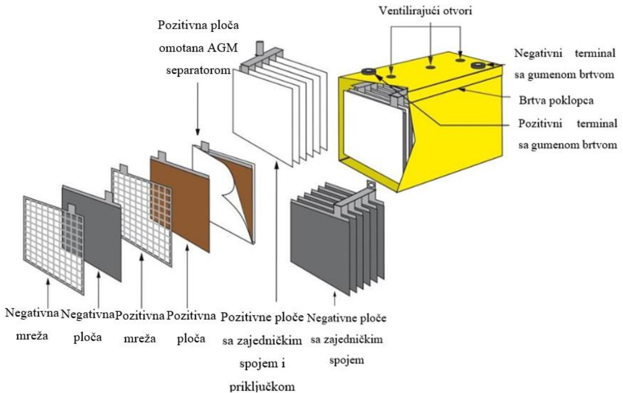
*Slika 3.6. Konstrukcija VRLA baterije u AGM izvedbi [16]*
