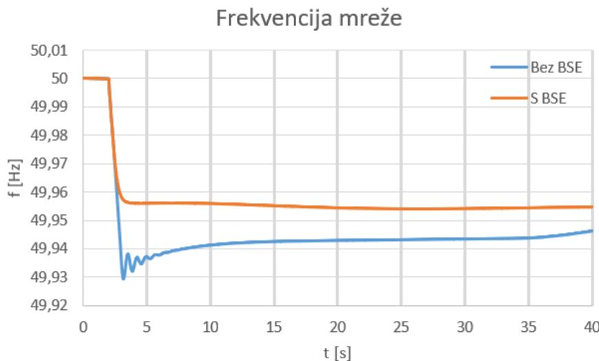
Slika 6.9. Utjecaj na fekvenciju uslijed povećanja opterećenja za 5%
