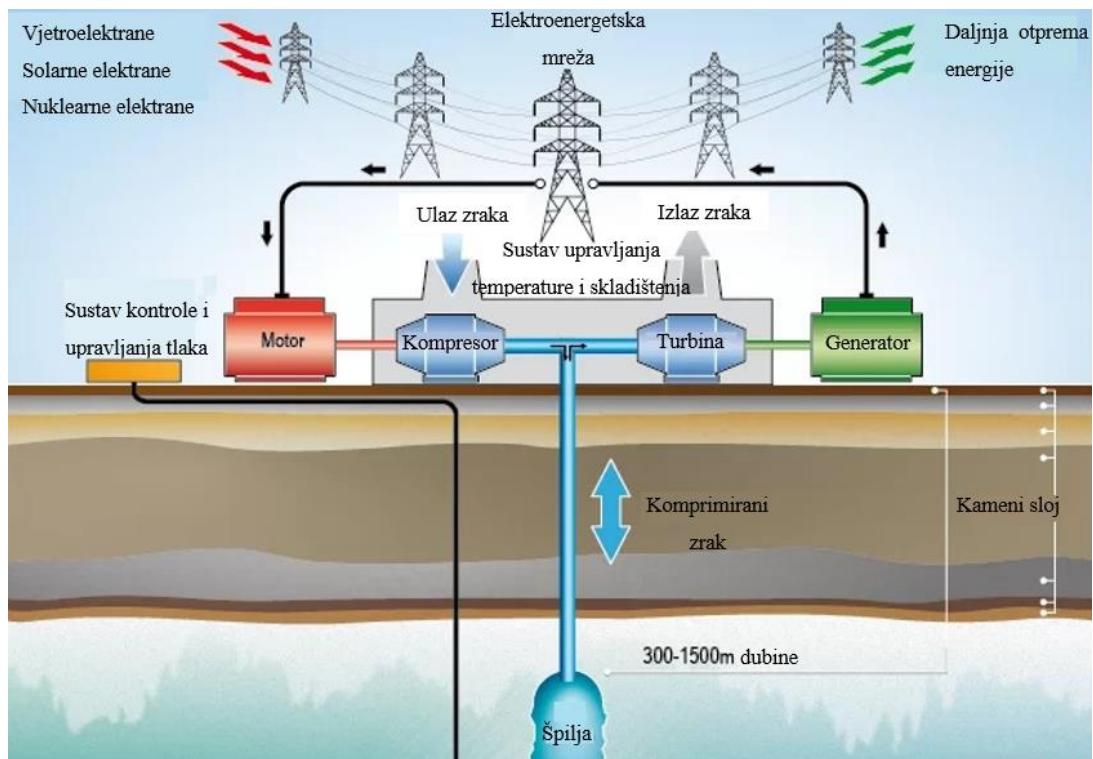
Slika 3.2. Pojednostavljeni prikaz sustava za skladištenje komprimiranog zraka [9]
