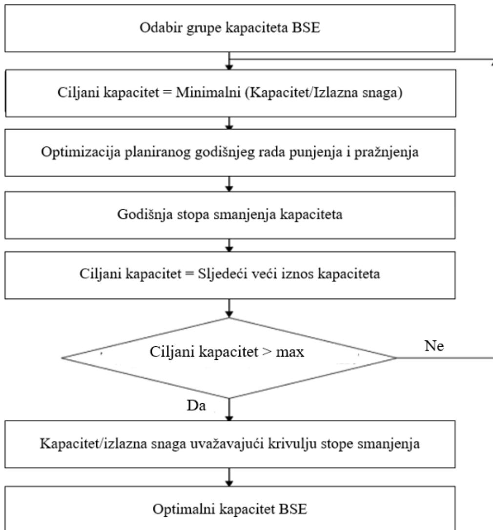
Slika 5.2. Dijagram optimalne metode za dimenzioniranje kapaciteta BSE [25]
