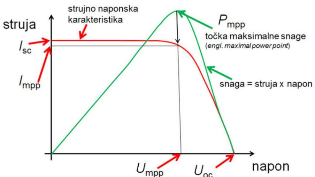
Slika 2.8. U-I karakteristika solarne čelije [32]
