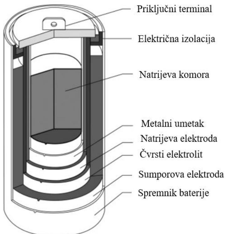
Slika 3.8. Presjek NaS baterijske čelije [18]
