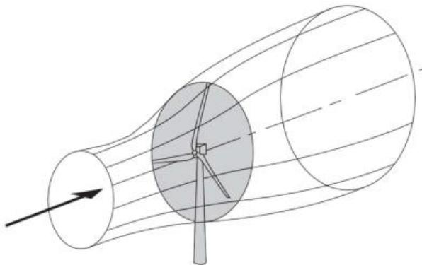
Slika 2.9. Strujanje zraka primjenjujući model aktuatororskog diska [6]
