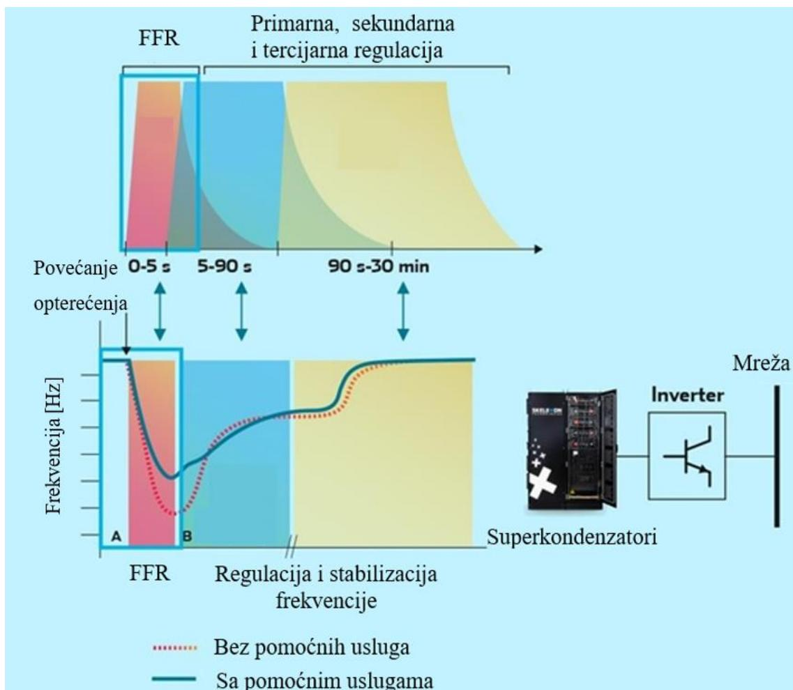
Slika 3.4. Utjecaj superkondenzatora na frekvenciju u mreži [10]
