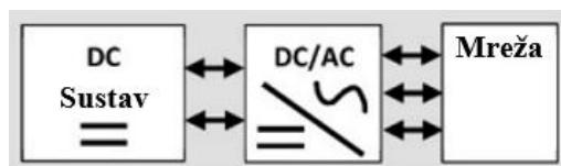
Slika 5.4. Direktna pretvorba energije iz istosmjerne u izmjeničnu [22]
