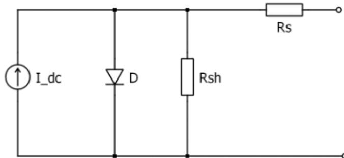
Slika 2.7. Ekvivalentna shema solarne čelije
