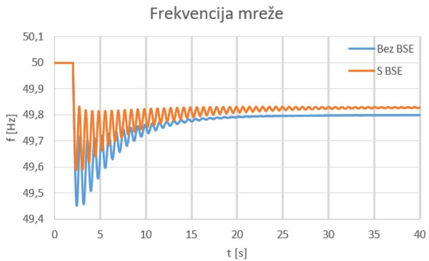
Slika 6.17. Utjecaj na frekvenciju uslijed ispada vjetroelektrane
