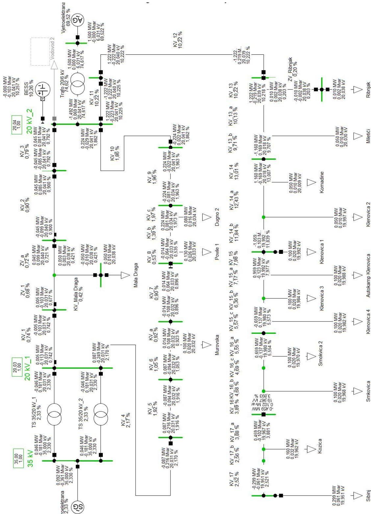
Slika 6.8. Tokovi snaga za vrijeme razdoblja niskog opterećenja s ugradenim BSE
