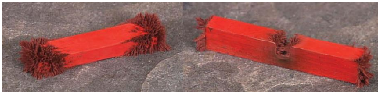
Slika 4.5. Princip rada ispitivanja magnetskim česticama [13]
