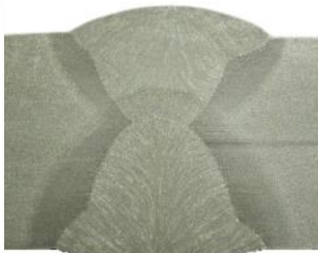
Slika 2.1. Presjek zavarenog spoja s karakterističnim zonama [5]
