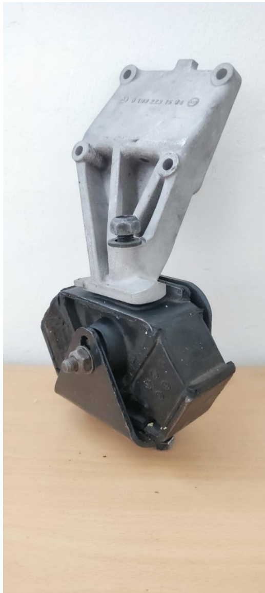
Slika 1. Sklop nosača motora i gume
